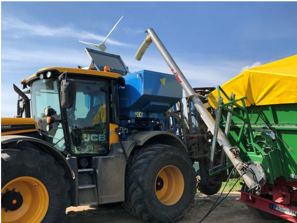
Aufbautank JAT 2519 - für JCB Fastrac Inhalt 1900 Liter, Tankbreite 2,50 m - hydraulisch betätigtes Klappdach - große Öffnung zum Befüllen des Tanks Dügebalken an Säkombination 4,20 m Arbeitsbreite (Kundengerät) - geklappt
