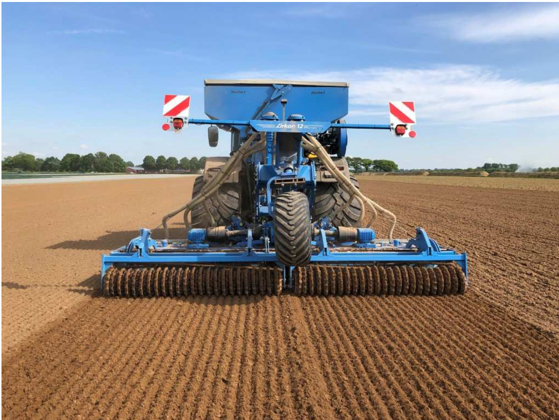
Aufbautank JAT 2519 - für JCB Fastrac Inhalt 1900 Liter, Tankbreite 2,50 m in Kombination mit Dügebalken an Säkombination 4,20 m Arbeitsbreite (Kundengerät) - hohe Ausbringleistung - Reichert-Druckdosierung - Halbseitenabschaltung - 2 Verteiler
