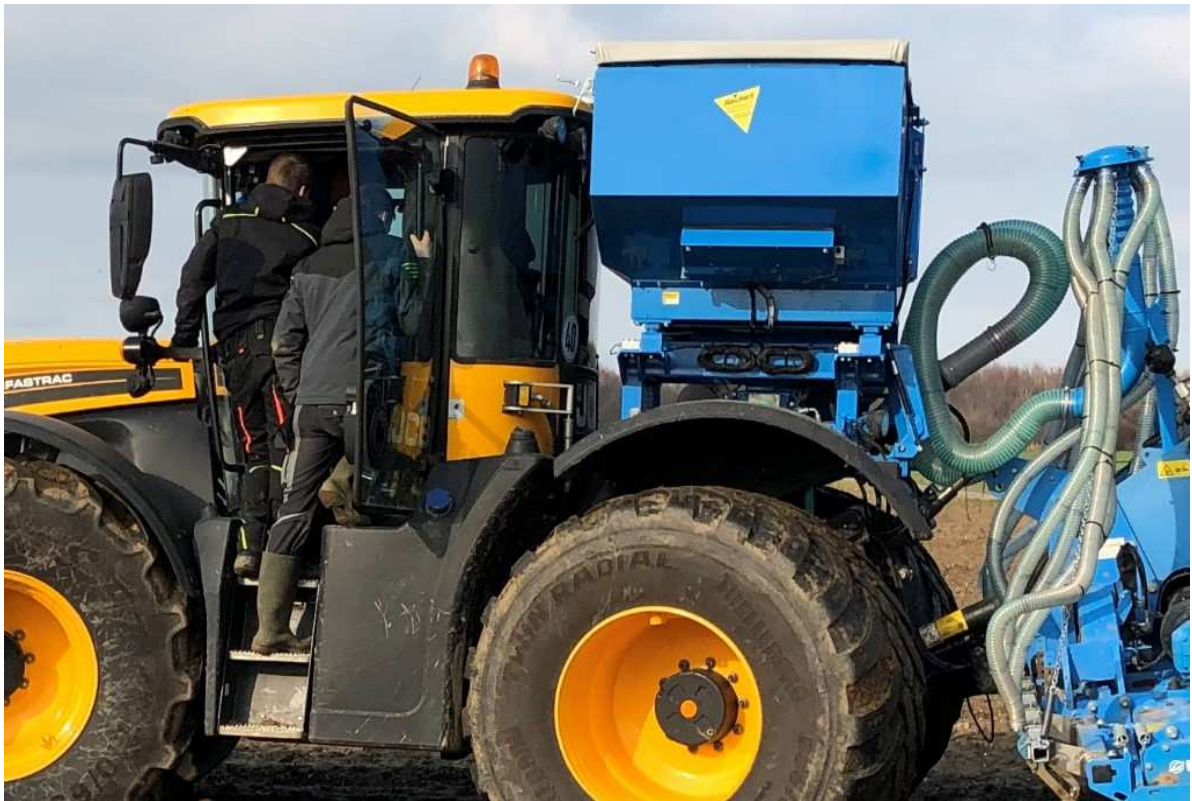
Aufbautank JAT 2519 - für JCB Fastrac Inhalt 1900 Liter, Tankbreite 2,50 m in Kombination mit Düngebalken an Säkombination 4,20 m Arbeitsbreite (Kundengerät) - hohe Ausbringleistung - Reichert-Druckdosierung - Halbseitenabschaltung - 2 Verteiler
