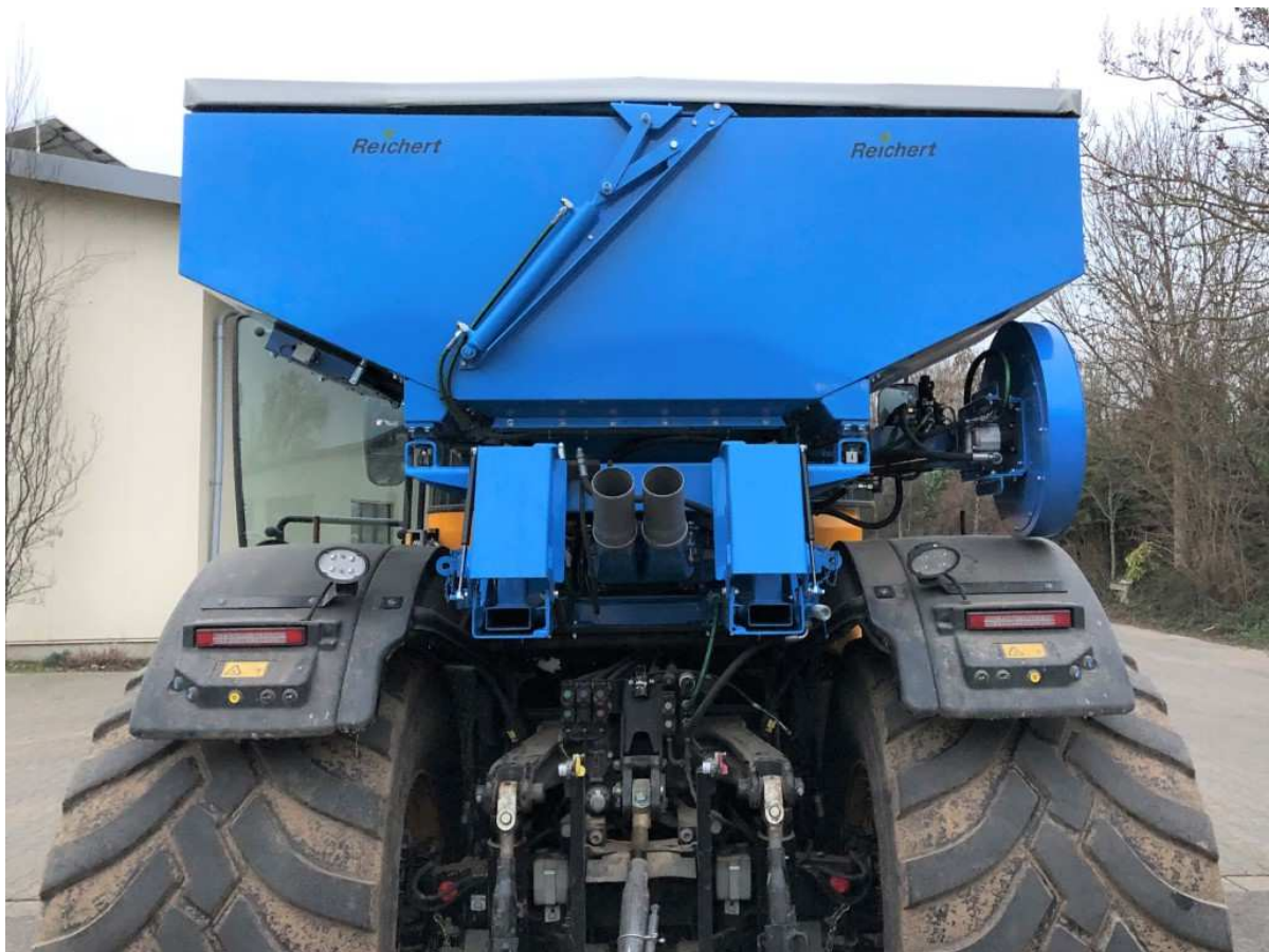
Aufbautank JAT 2519 - für JCB Fastrac Inhalt 1900 Liter, Tankbreite 2,50 m - mit Aufbaurahmen auf JCB, Tank mit Gabelstapler auf- und abbaubar, Tank hydraul. verschiebbar - hohe Ausbringleistung - Reichert-Druckdosierung - Halbseitenabschaltung
