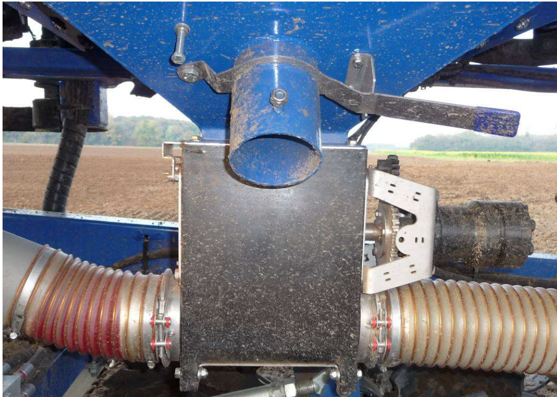
Bild 3 Druckdosierung Köckerling , hydraulischer Antrieb, Rechner gesteuert - einfache Förderleitung Ø125
