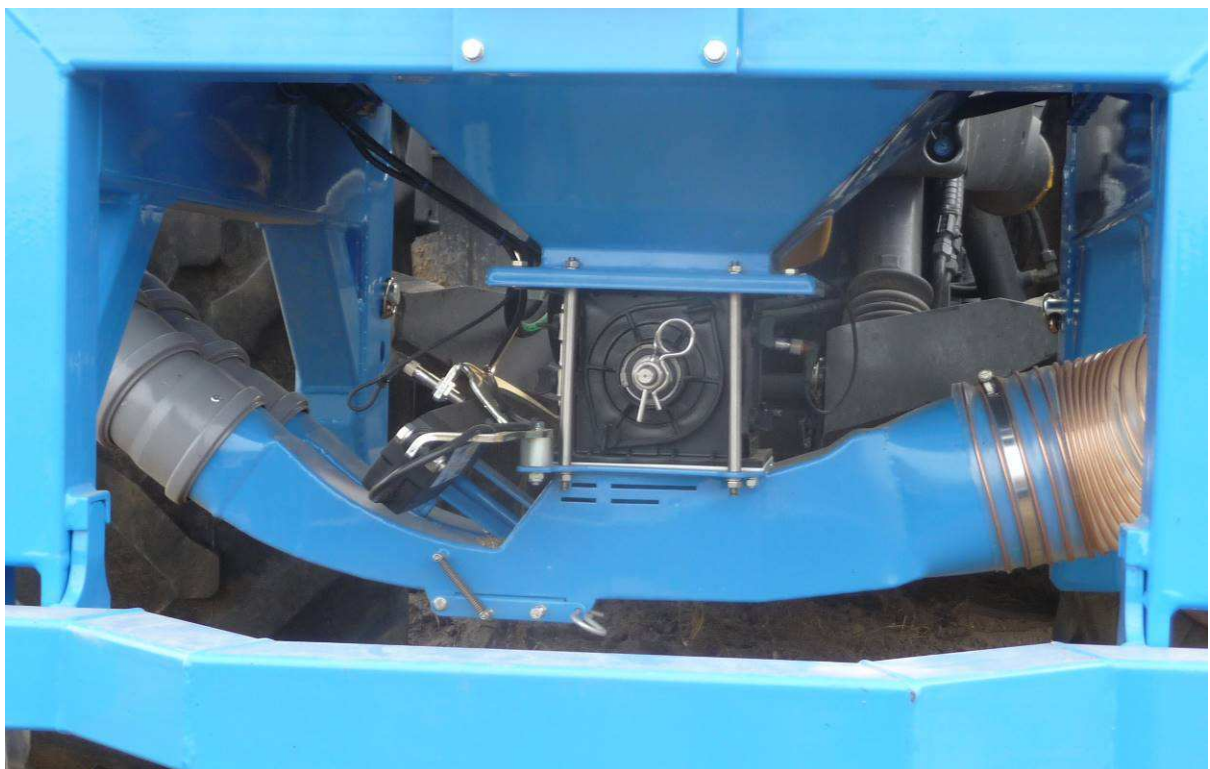
Bild 2 Horsch-Dosiergerät , elektrischer Antrieb, Rechner gesteuert - doppelte Injektorschleuse - mit elektrischer Halbseiten-Abschaltung (Wunschausrüstung) - 2 Förderleitungen Ø110
