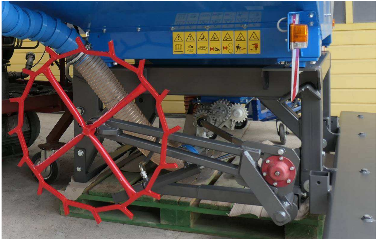
Bild 7 Accord-Dosiergerät , mechanischer Antrieb - angetrieben über Spornrad
