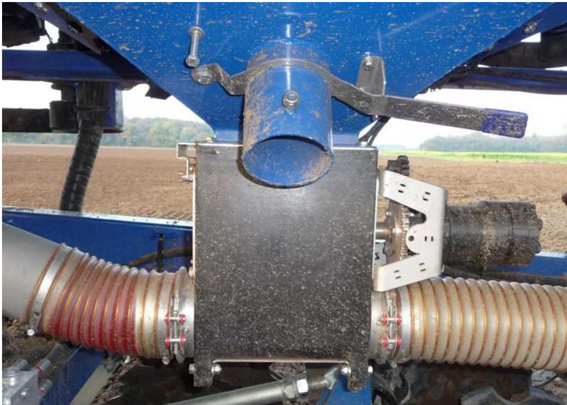
- Druckdosierung Köckerling, hydraulisch angetrieben, Rechner gesteuert
