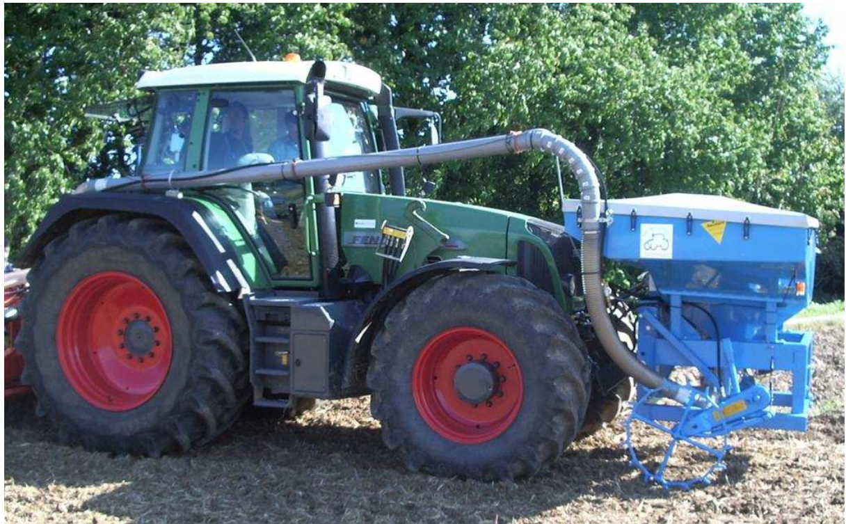
- FTK mit Accord-Dosiergerät, mechanischer Antrieb über Spornrad
