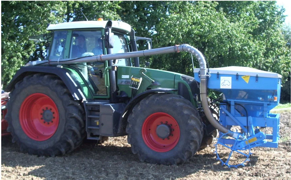
- FTK mit Accord-Dosiergerät, mechan. Antrieb über Spornrad
