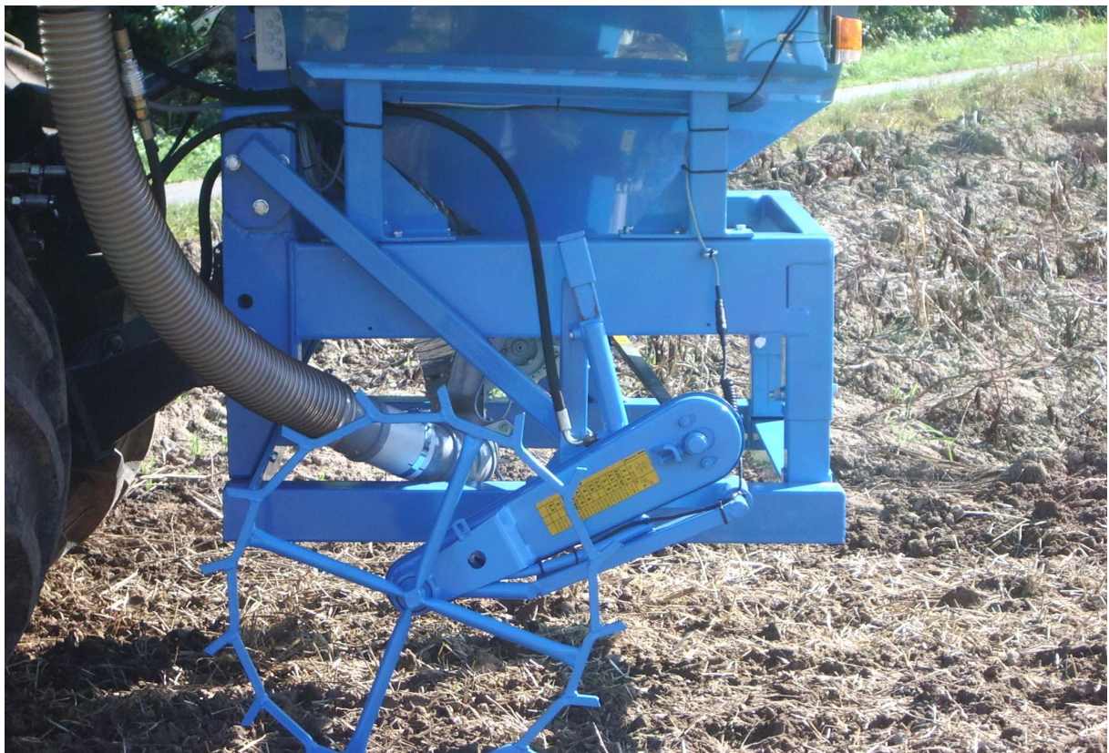
- mechanischer Antrieb über Spornrad
