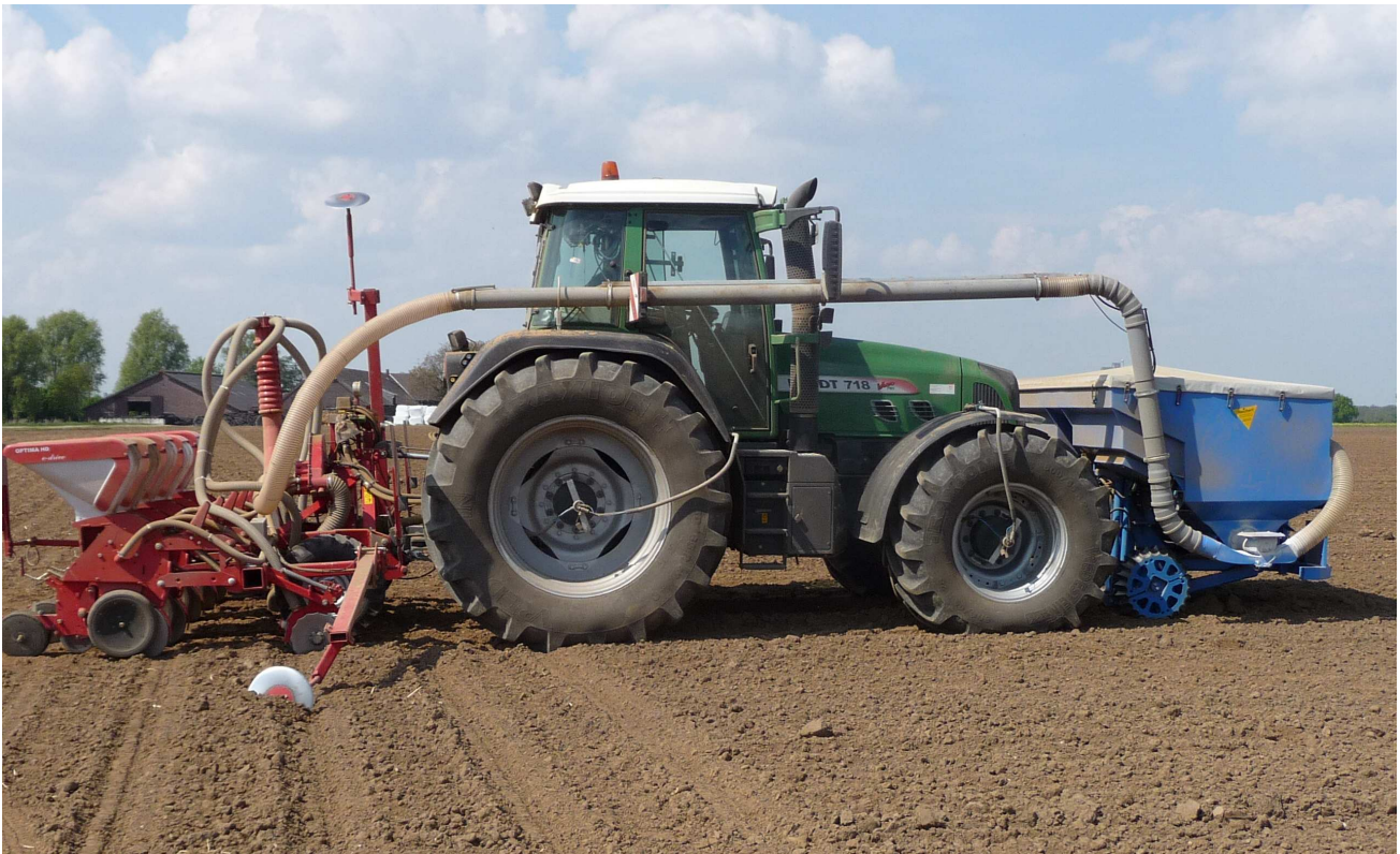
Fronttank FT 2527 mit Schneckendosierung Inhalt 2700 Liter, Tankbreite 2,50 m in Kombination mit Maissägerät, Arbeitsbreite 3,75 m - mit Verteilersystem Düngung, 1 Verteilerkopf - Förderleitung Ø125 mm
