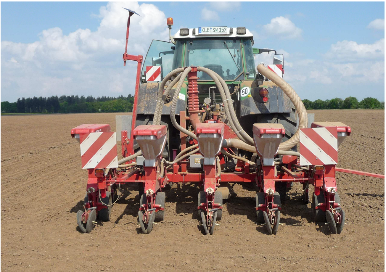
Verteilersystem Düngung, 1 Verteilerkopf montiert auf Maissägerät, Arbeitsbreite 3,75 m - mit Wellrohr Ø135 mm - mit Dünge Schlauch Ø54 mm zum Dünge schar
