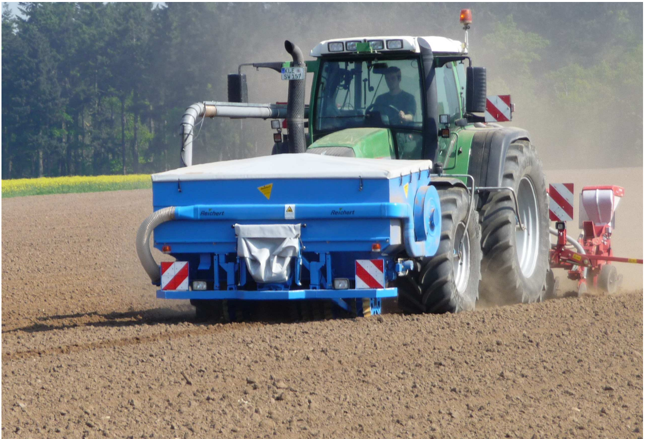
Fronttank FT 2527 mit Schneckendosierung Inhalt 2700 Liter, Tankbreite 2,50 m in Kombination mit Maissägerät, Arbeitsbreite 3,75 m - mit Befüllschnecke mit Klapptrichter (Wunschausrüstung) - mit langer Stossstange kpl. mit Arbeitsscheinwerfern und Warntafeln (Wunschausrüstung)
