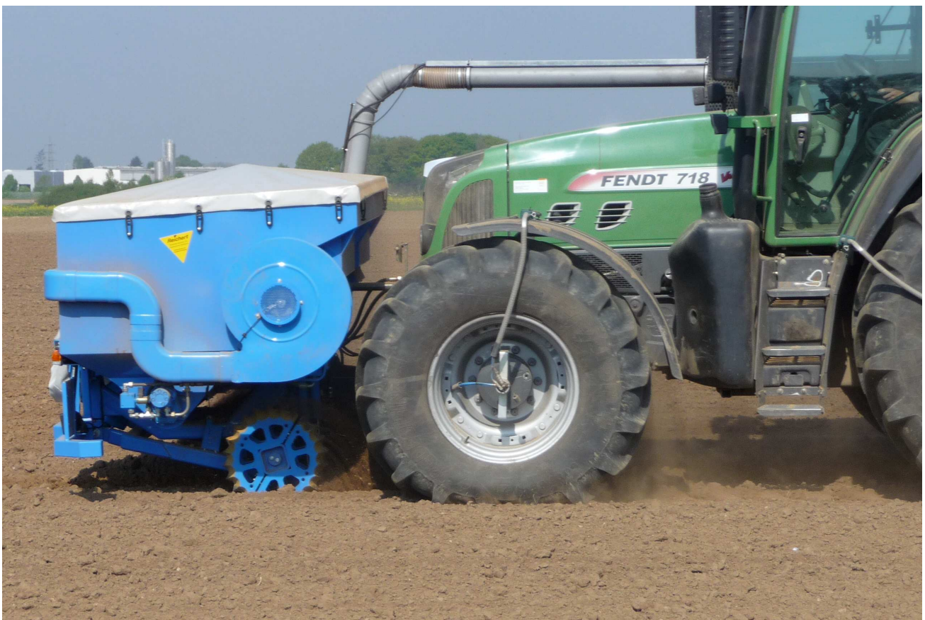
Fronttank FT 2527 mit Schneckendosierung Inhalt 2700 Liter, Tankbreite 2,50 m - mit Walze, hydraulisch aushebbar (Wunschausrüstung)
