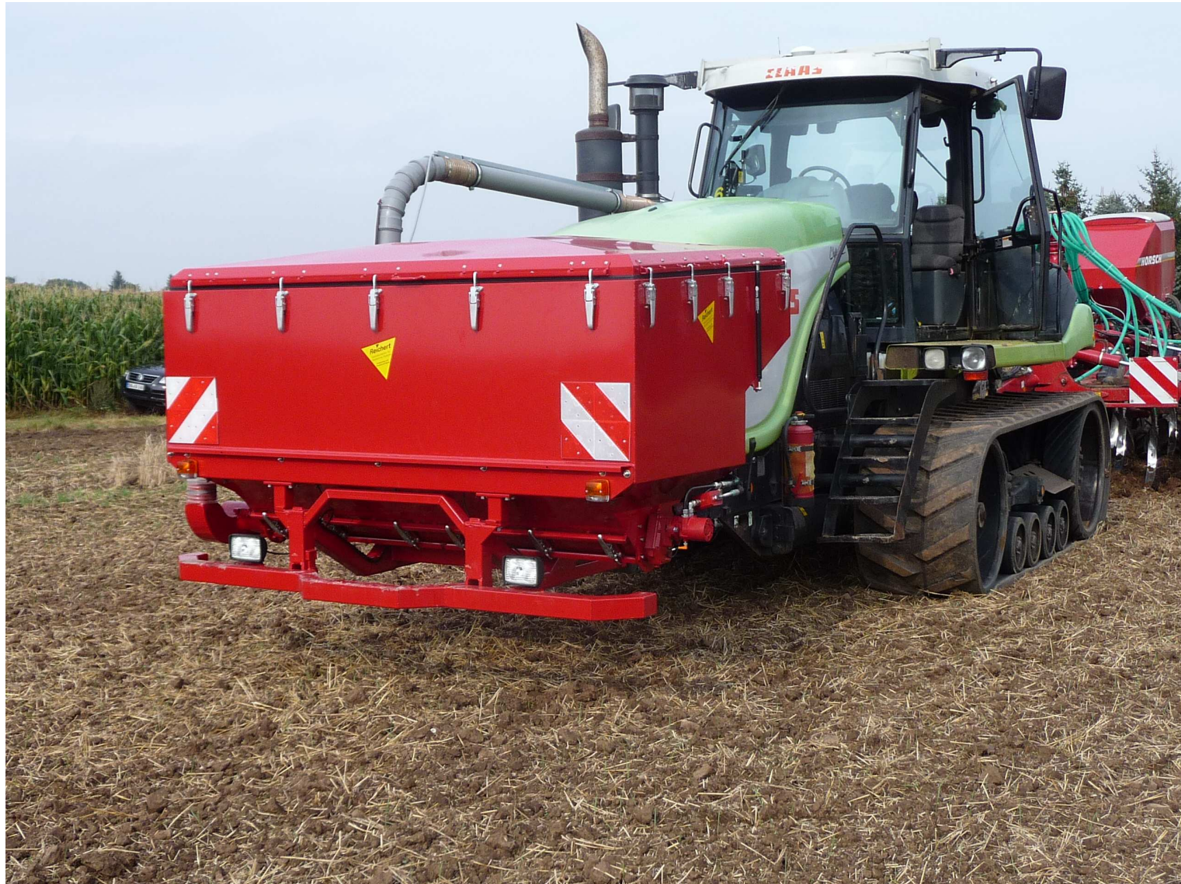
Front-Drucktank FDT 2326 Inhalt 2600 Liter, Tankbreite 2,30 m mit Adapter für starren Anbau an Raupe
