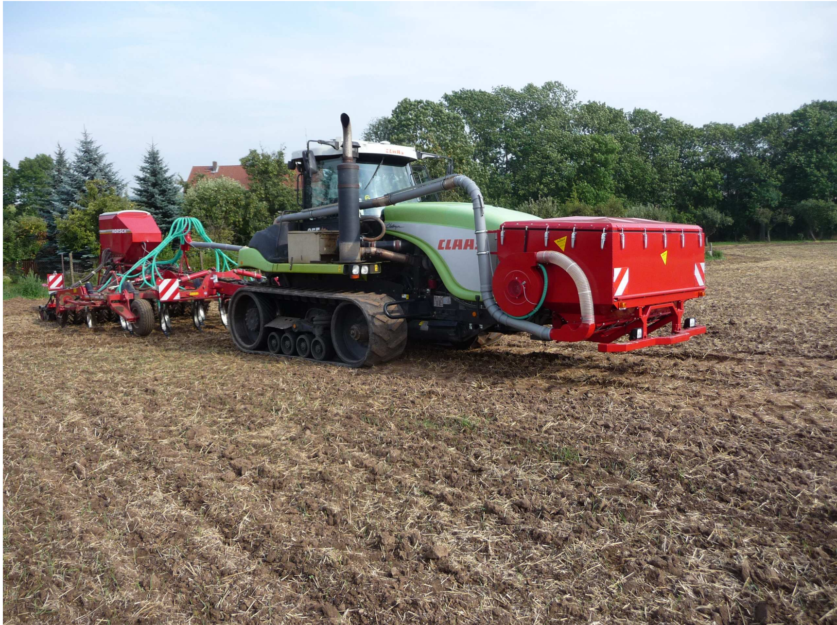
Front-Drucktank FDT 2326 Verteilersystem Düngung mit 1 Verteilerkopf in Kombination mit Tiefengrubber und Drille
