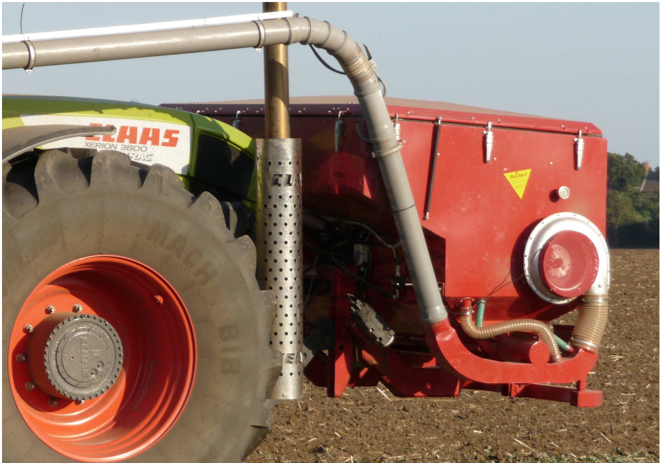
Frontdrucktank FDT2531 mit Schneckendosierung Inhalt 3100 Liter, Tankbreite 2,5 m - Druckschleuse mit Förderleitung - Druckdeckel, klappbar
