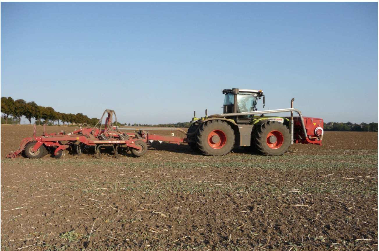
Frontdrucktank FDT2531 mit Schneckendosierung in Kombination mit Grubber
