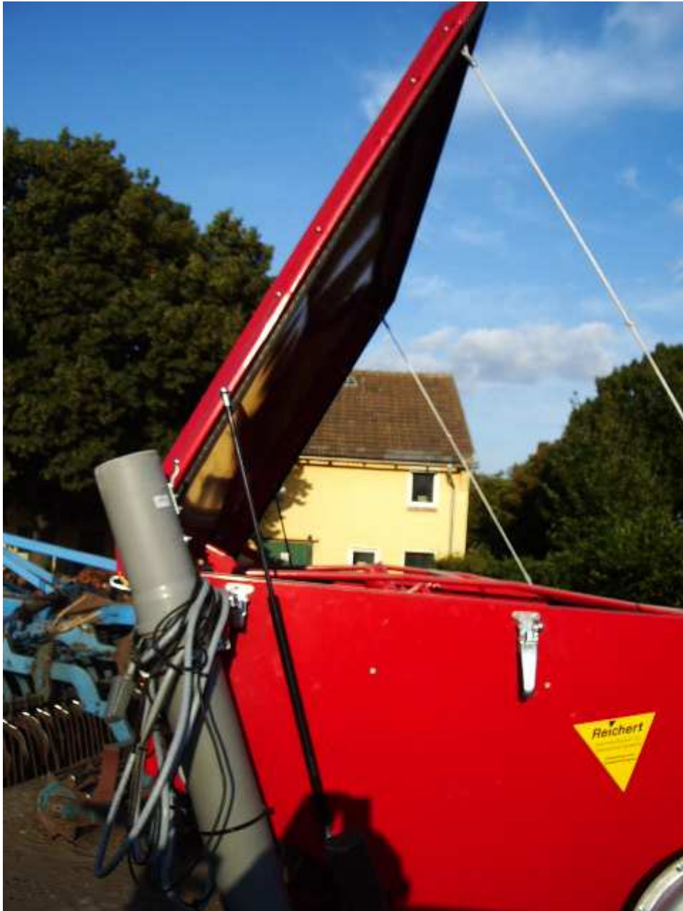
Frontdrucktank FDT2531 mit Schneckendosierung - Druckdeckel, geöffnet
