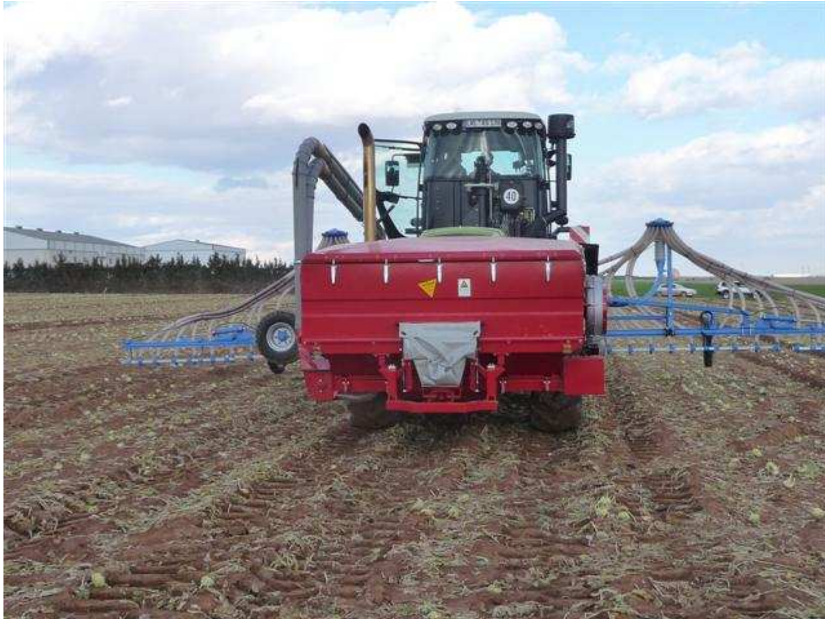
Frontdrucktank FDT2528K mit Kettendosierung Inhalt 2800 Liter, Tankbreite 2,50 m - Verteilersystem mit 2 Verteilern - Befüllschnecke in Kombination mit Düngerahmen, Arbeitsbreite 12 m
