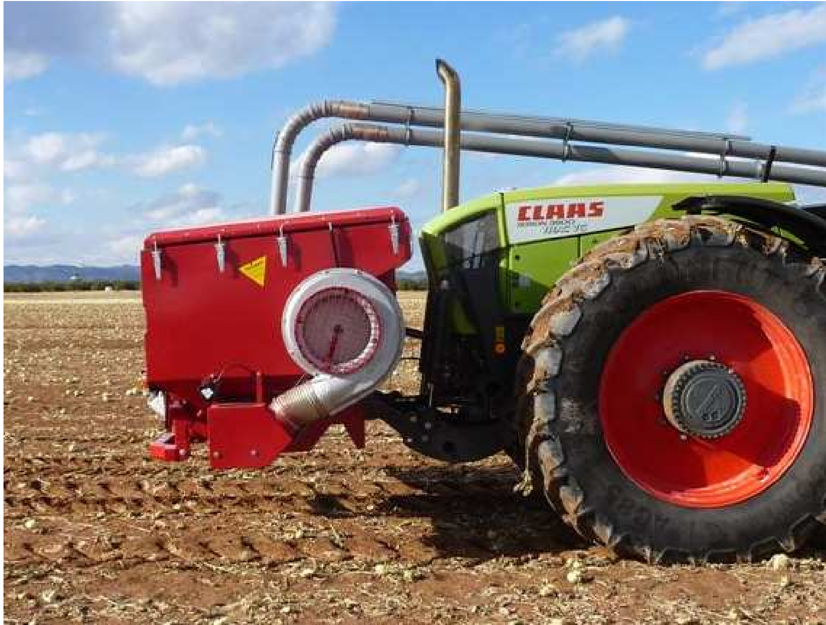
Frontdrucktank FDT2528K mit Kettendosierung Inhalt 2800 Liter, Tankbreite 2,50 m - Befüllschnecke - Gebläse - 2 Förderleitungen für Verteilersystem mit 2 Verteilern
