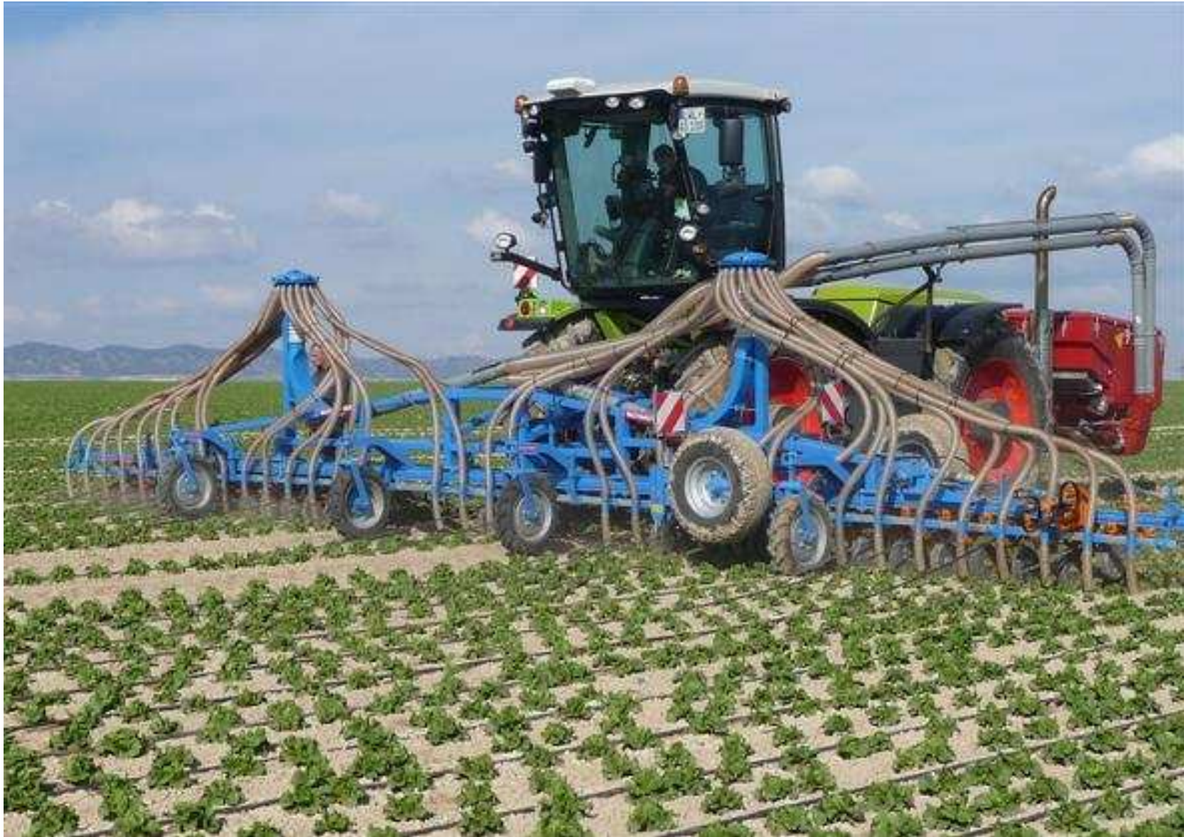
Frontdrucktank FDT2528K mit Kettendosierung Inhalt 2800 Liter, Tankbreite 2,50 m - Verteilersystem mit 2 Verteilern in Kombination mit Düngerahmen und Hacke, Arbeitsbreite 12 m
