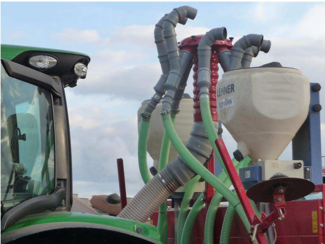
Verteilersystem Düngung, 1 Verteilerkopf montiert auf Kartoffellegegerät, Arbeitsbreite 3 m - Förderleitung mit Wellrohr Ø160 mm - Verteilerkopf mit 8 Abgängen Ø75 mm und Entlüftungs-T-Stück
