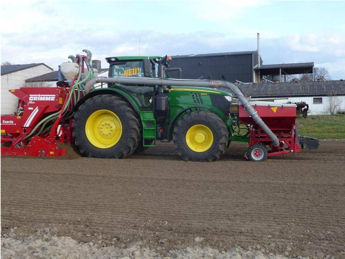
Verteilersystem Düngung, 1 Verteilerkopf montiert auf Kartoffellegegerät, Arbeitsbreite 3 m - Förderleitung mit Wellrohr Ø160 mm - in Kombination mit Fronttank FTK 2522 (Inhalt 2200 Liter, Tankbreite 2,50 m)
