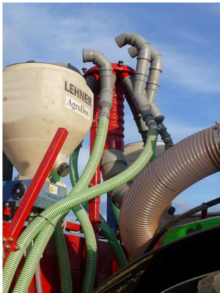
Verteilersystem Düngung, 1 Verteilerkopf montiert auf Kartoffellegegerät, Arbeitsbreite 3 m - Förderleitung mit Wellrohr Ø160 mm - Verteilerkopf mit 8 Abgängen Ø75 mm und Entlüftungs-T-Stück
