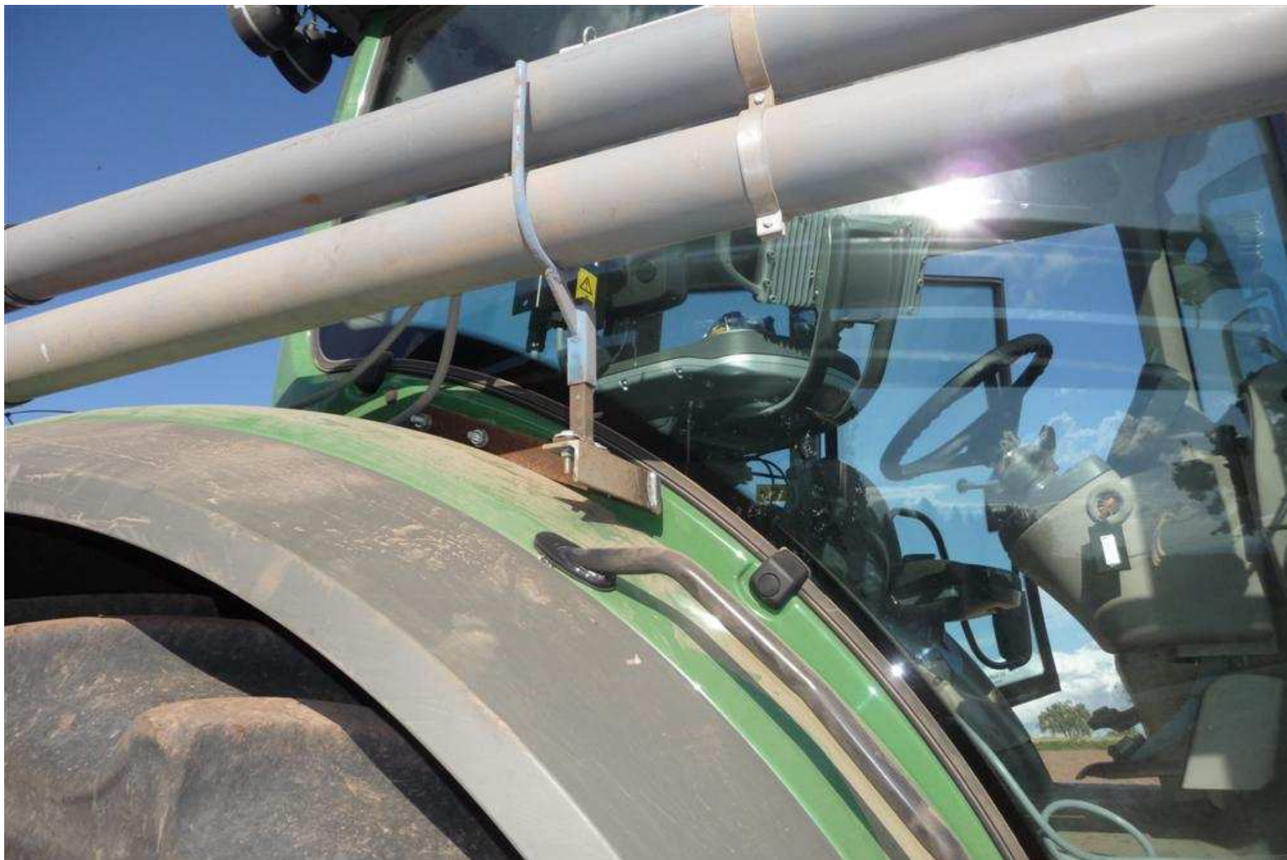
Förderrohrleitungen Ø110 mm - Halterung am Schlepper
