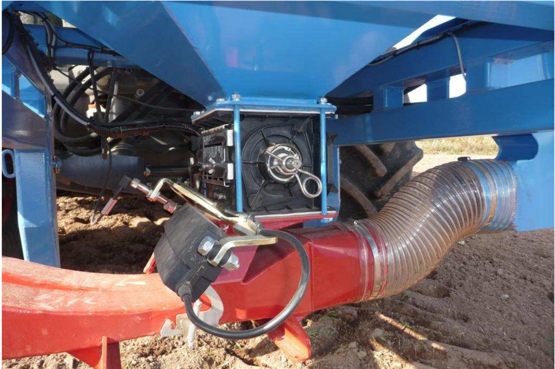
Fronttank FTK 2524 H mit Horsch-Dosiergerät - doppelte Injektorschleuse Ø110mm - elektr. Halbseitenabschaltung
