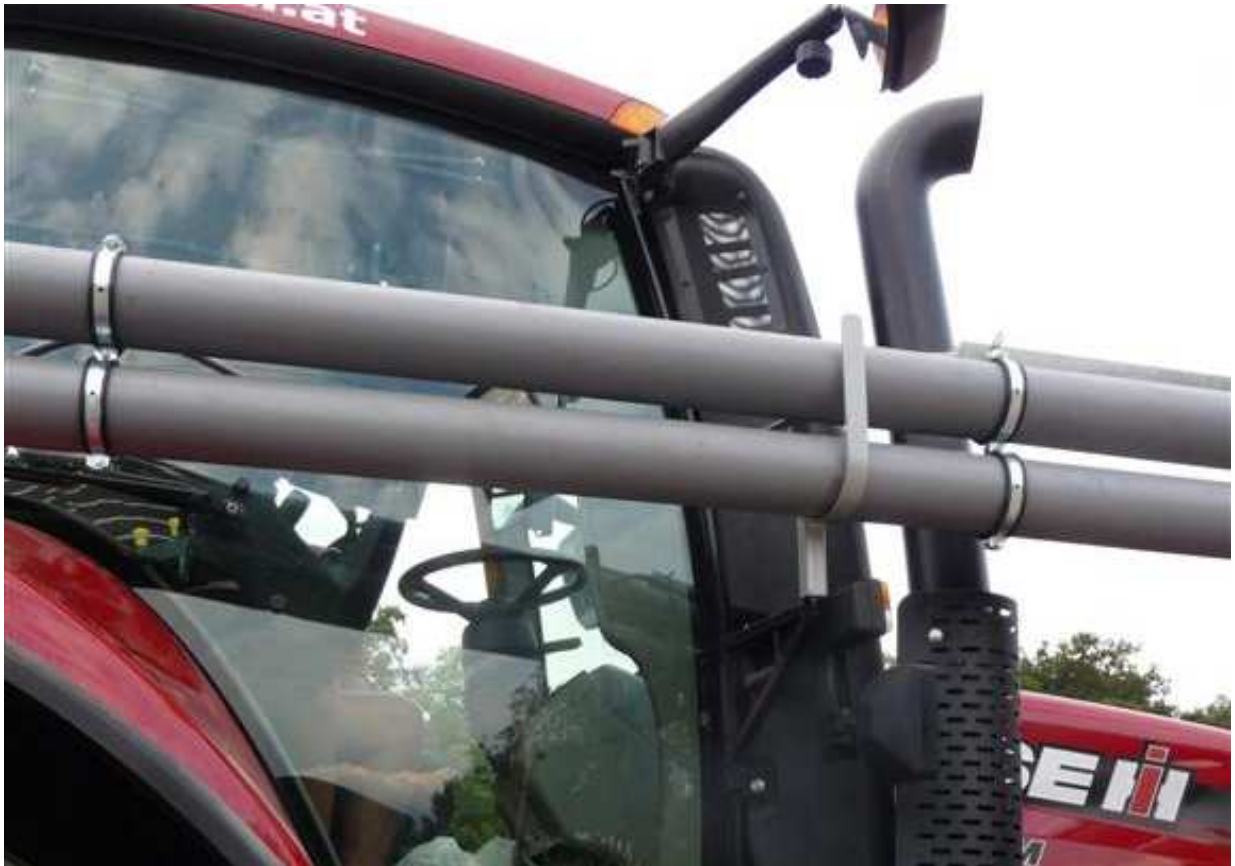
2 Förderleitungen Ø110 mm - mit U-Steckbügel / hintere Förderrohr-Halterung, Standard: Steckmontage auf Kotflügel - Foto: Montage an Halterung (Kundenlösung)
