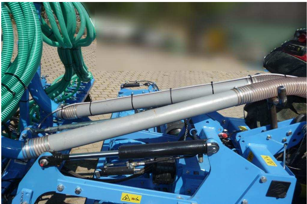
2 Förderleitungen Ø110 mm auf Lemken Säkombination, 6 m Arbeitsbreite - mit U-Halterung, auf Lemken Kreiselegge - mit 2 Säverteilern, Rohrbogen mit Wellrohr, Halterungen, Säschlauch
