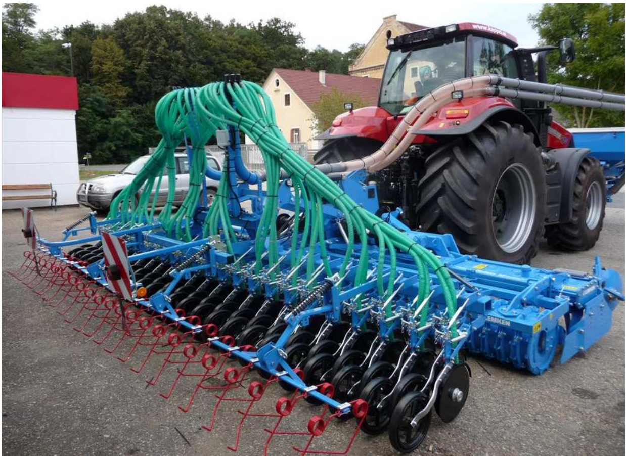
Verteilersystem Saat auf Lemken Säkombination, 6 m Arbeitsbreite - mit 2 Säverteiltern (je 20 oder 24 Abgänge), Rohrbogen mit Wellrohr, Halterungen, Säschauch - 2 Förderleitungen Ø110 mm am Fronttank, mit Halterungen
