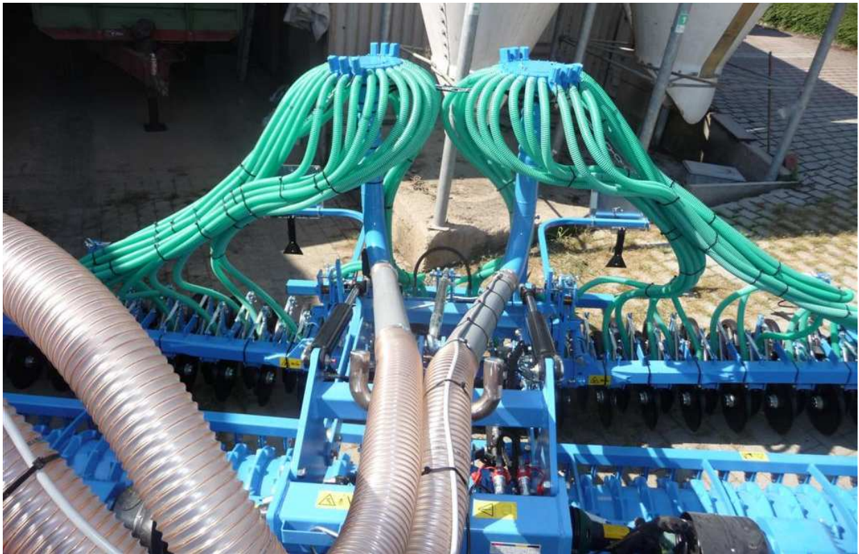
2 Förderleitungen Ø110 mm auf Lemken Säkombination, 6 m Arbeitsbreite - 2 Förderleitungen Ø110 mm - mit U-Halterung, auf Lemken Kreiselegge - mit 2 Säverteiltern (je 20 oder 24 Abgänge), Rohrbogen mit Wellrohr, Halterungen, Säschauch
