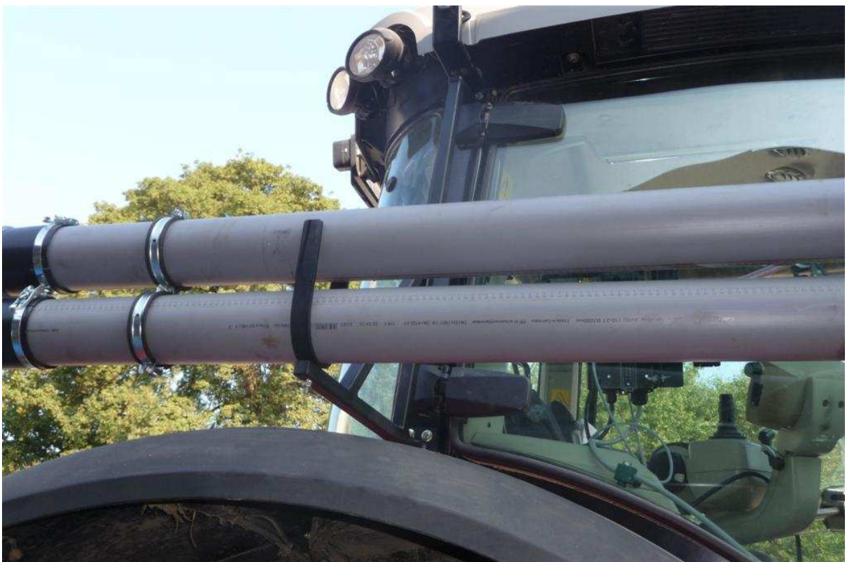
2 Förderleitungen Ø110 mm - mit U-Steckbügel / hintere Förderrohr-Halterung, Standard: Steckmontage auf Kotflügel - Foto: Montage an Halterung (Kundenlösung)
