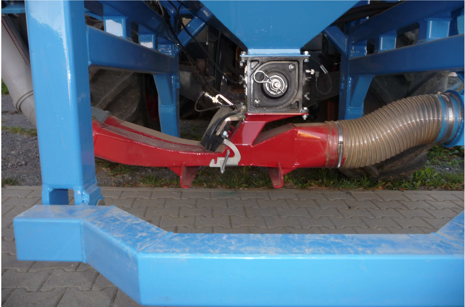
Fronttank FTK 2524 H mit Horsch-Dosiergerät - doppelte Injektorschleuße Ø110 mm - elektr. Halbseitenabschaltung
