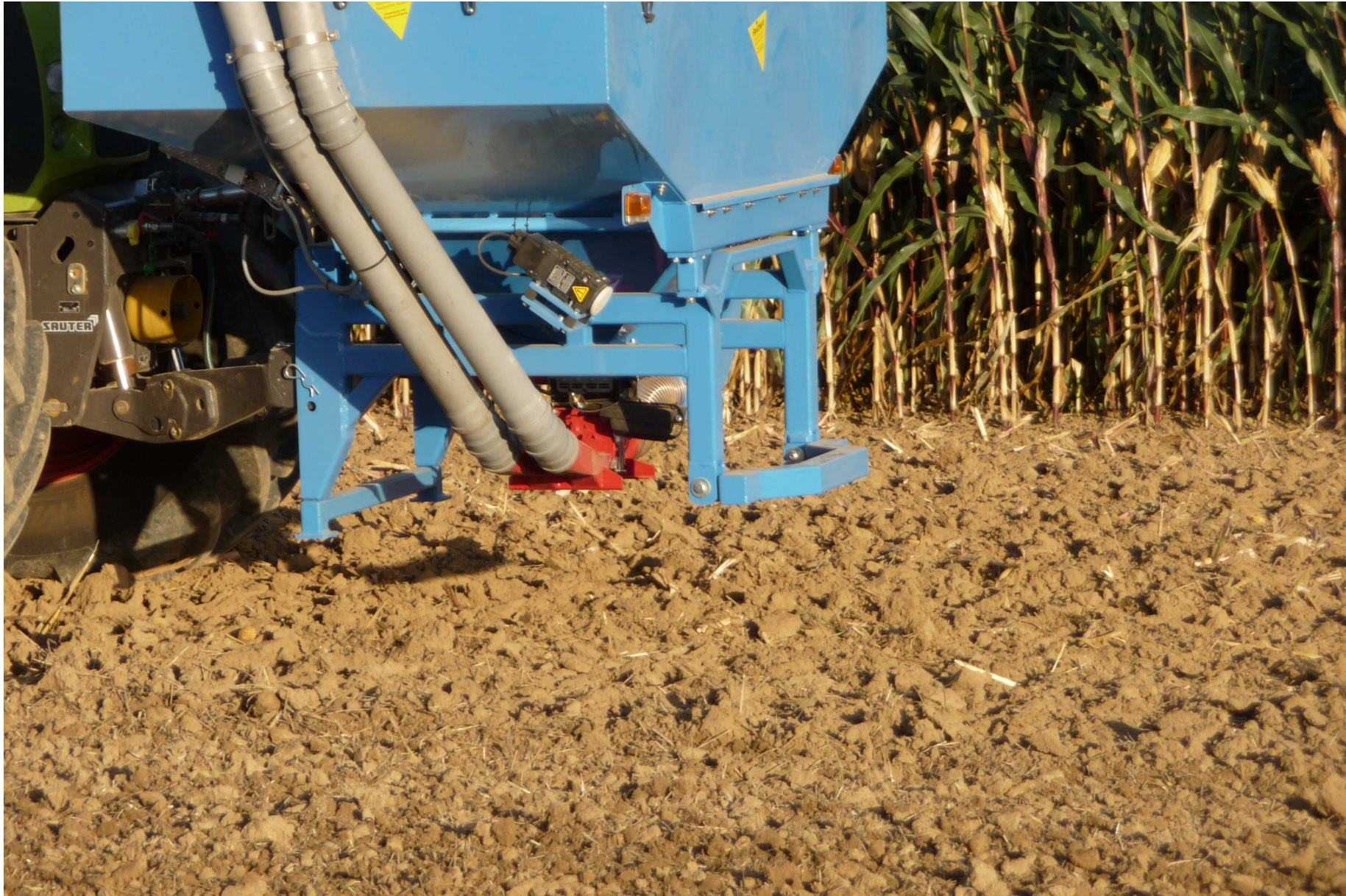
Fronttank FTK 2524 H mit Horsch-Dosiergerät - doppelte Injektorschleuße und Förderrohrleitungen Ø110 mm - Radarsensor
