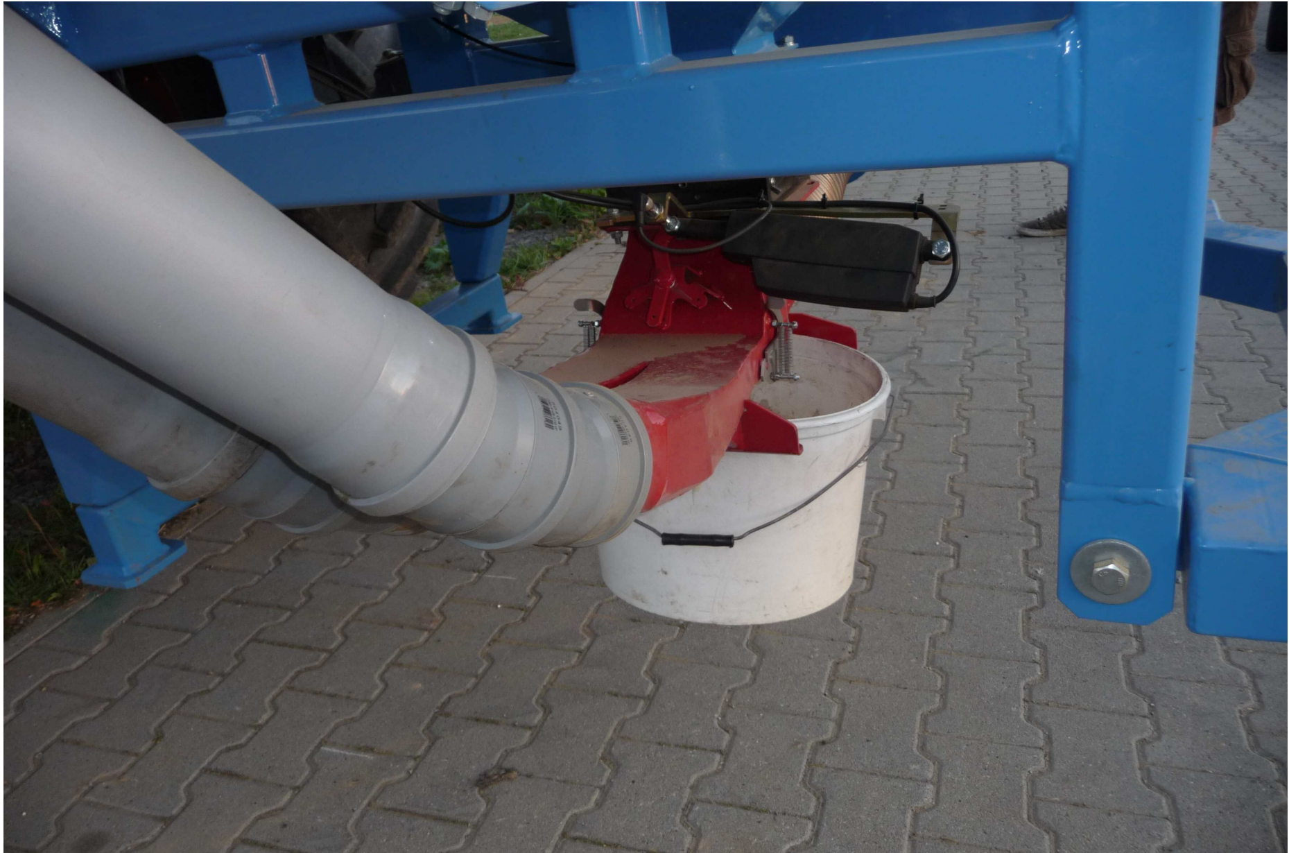
Fronttank FTK 2524 H mit Horsch-Dosiergerät - doppelte Injektorschleuße mit Förderleitungen Ø110 mm - beim Abdrehen
