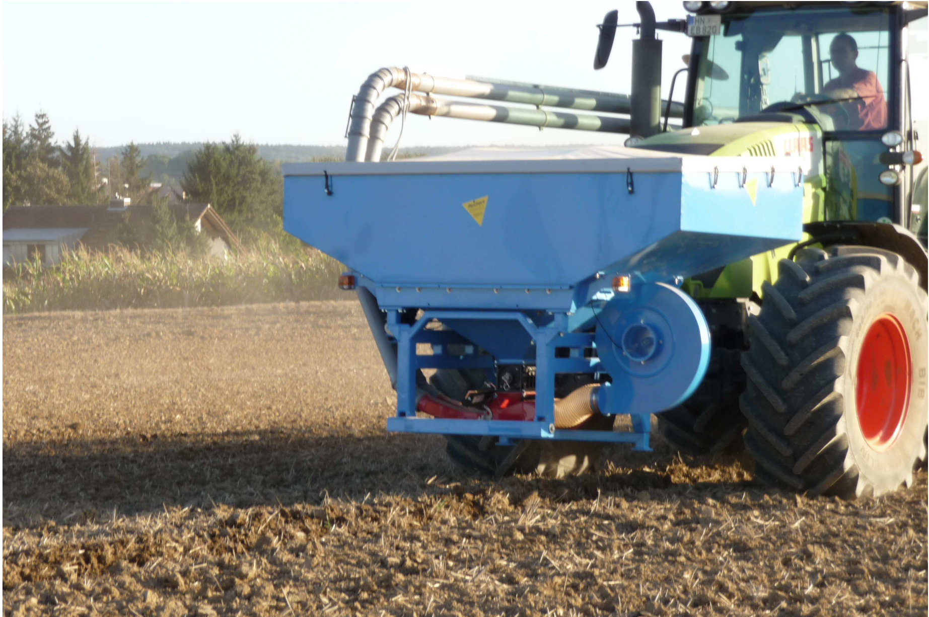
Fronttank FTK 2524 H mit Horsch-Dosiergerät - Gebläse - kurze Stoßstange
