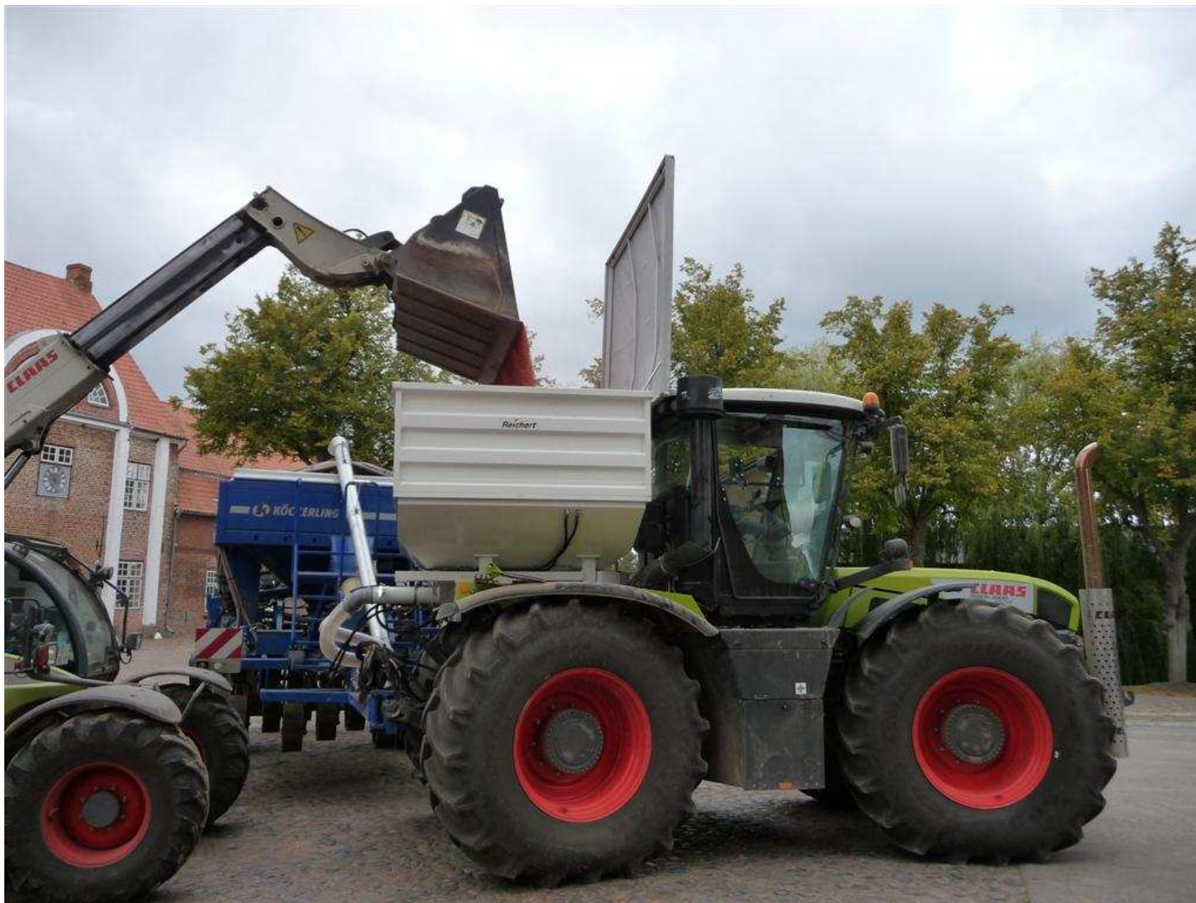
XEAT 1854 Inhalt 5400 Liter Befüllung mit Teleskoplader bei angehängter Köckerling Drillmaschine
