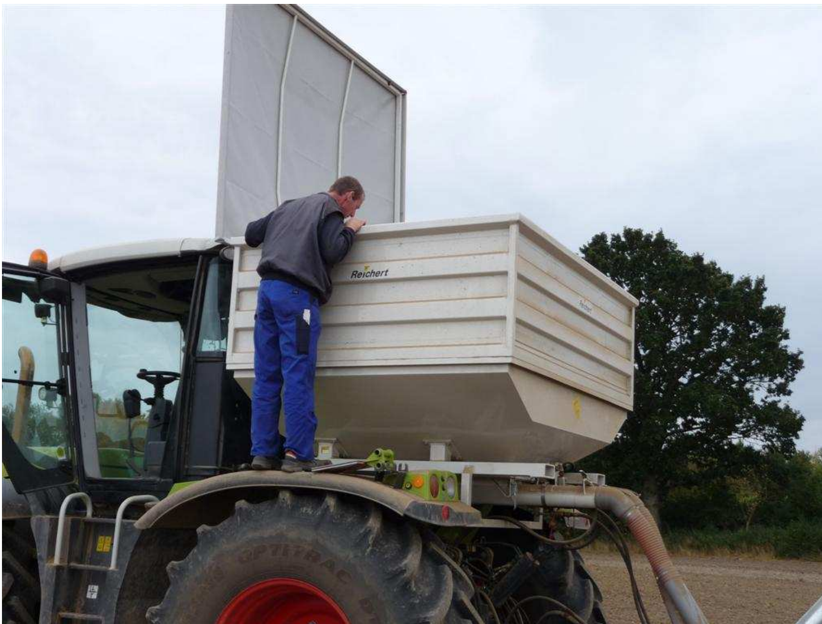
XEAT 1854 Inhalt 5400 Liter - mit 2 Tankschnecken - mit hydraulisch klappbarem Dach Dach nach vorne aufgeklappt
