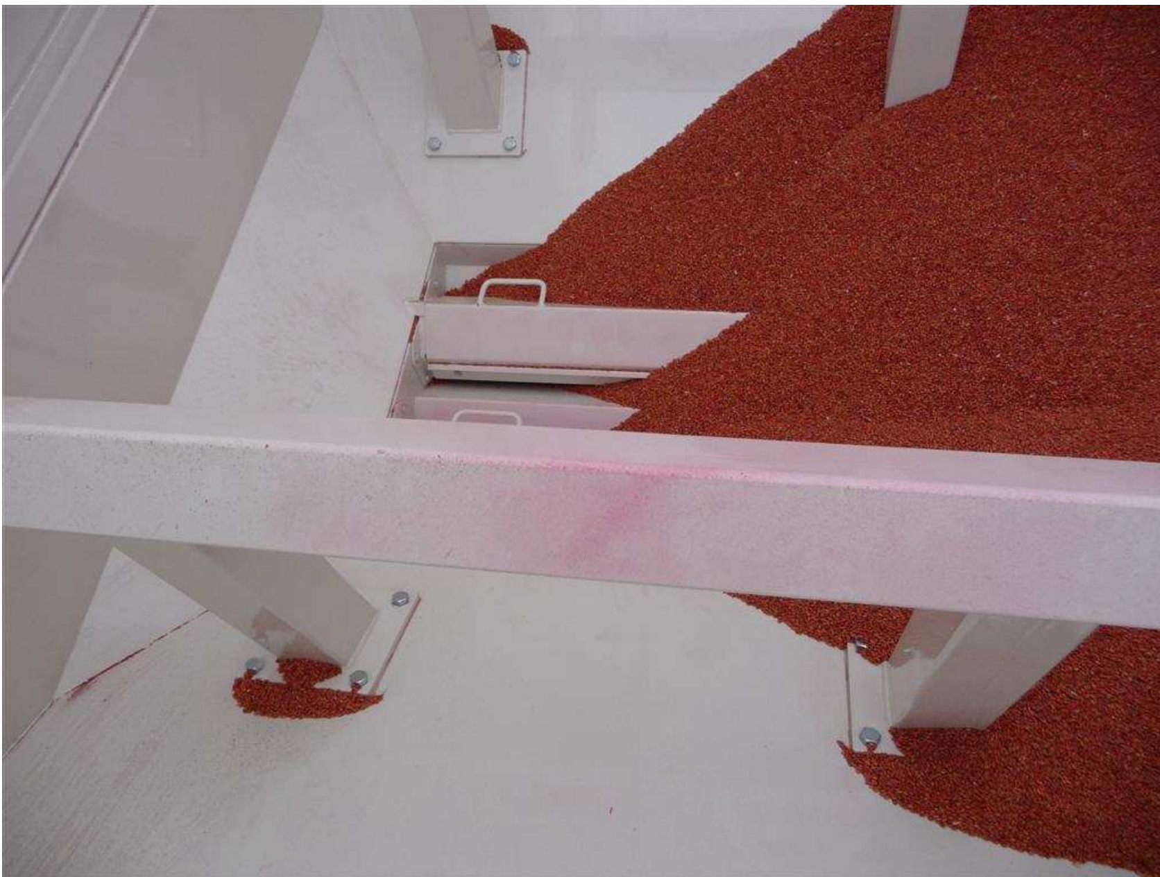
XEAT 1854 Tank innen 2 Tankschnecken mit Schneckendächern
