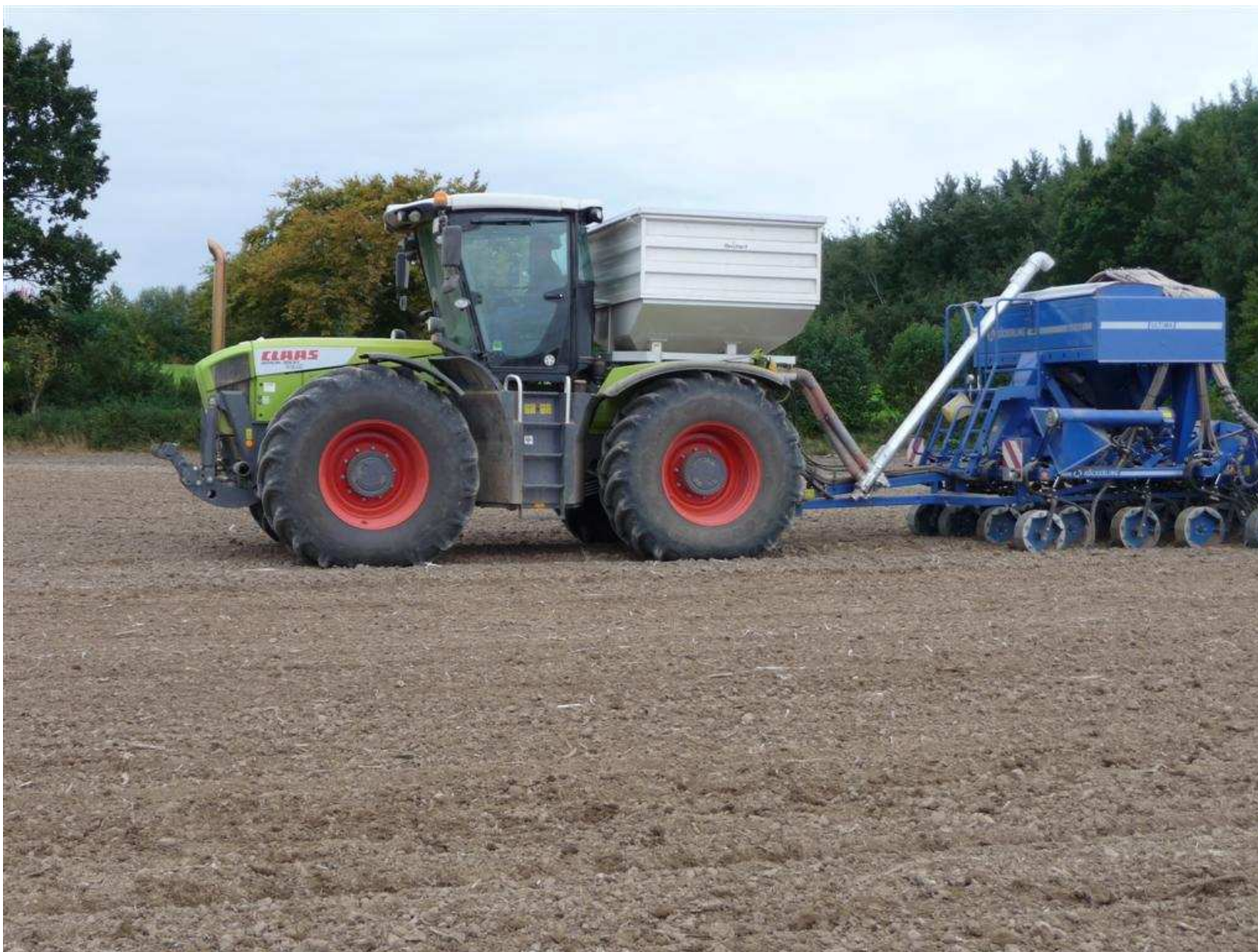
XEAT 1854 Inhalt 5400 Liter - mit 2 Tankschnecken - mit hydraulisch klappbarem Dach Umladeschnecke Ø150 mm für Drille auf Köckerling Drillmaschine
