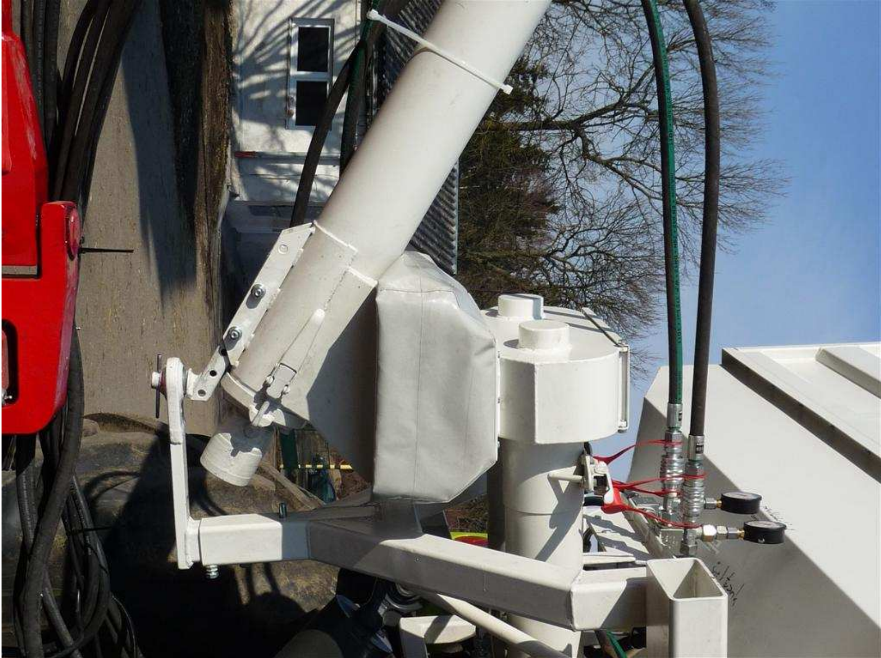
XEAT 1854 mit 2 Tankschnecken Tankschnecken-Zusammenführung Umladeschnecke Ø150 mm auf Drille
