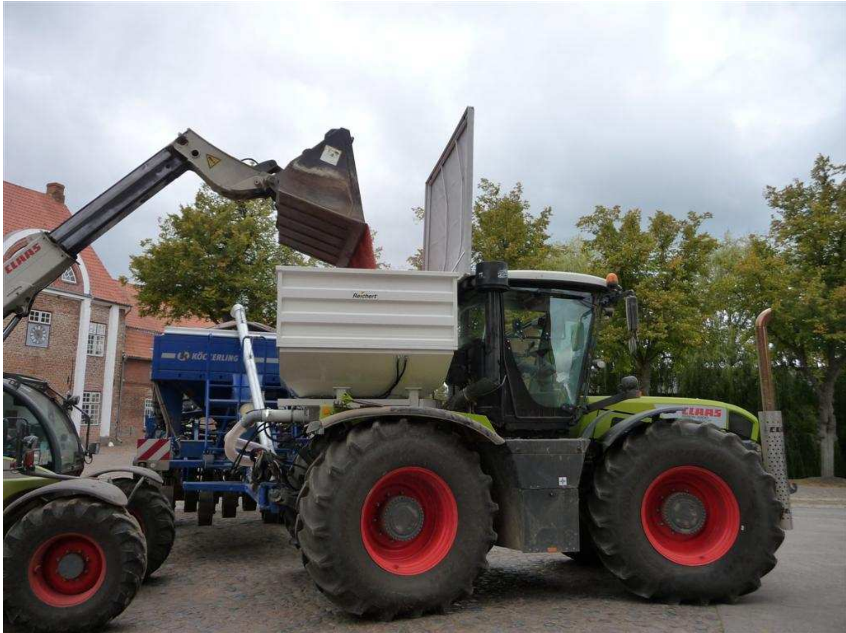
XEAT 1854 Inhalt 5400 Liter mit 2 Tankschnecken Befüllung mit Teleskoplader bei angehängter Drillmaschine
