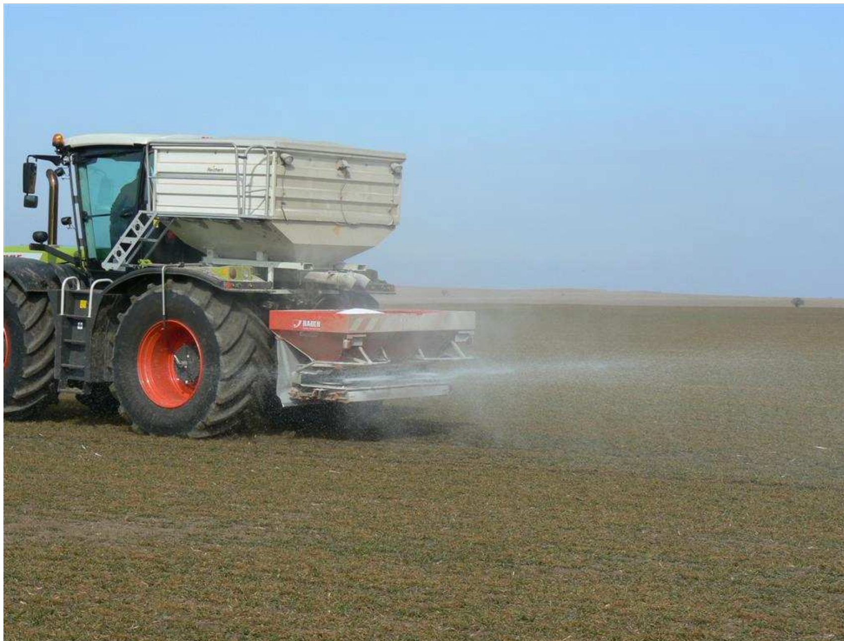
XEAT 1854 mit 2 Tankschnecken Umladen direkt in Rauch Düngerstreuer
