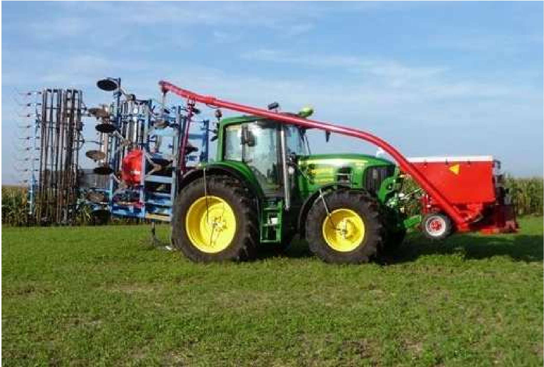
Fronttank FT2527 Inhalt 2700 Liter, Tankbreite 2,5 m Reifenpacker REPA - mit hydraul. Gewichtsausgleich Umladespirale Ø125 mm in Kombination mit Drille
