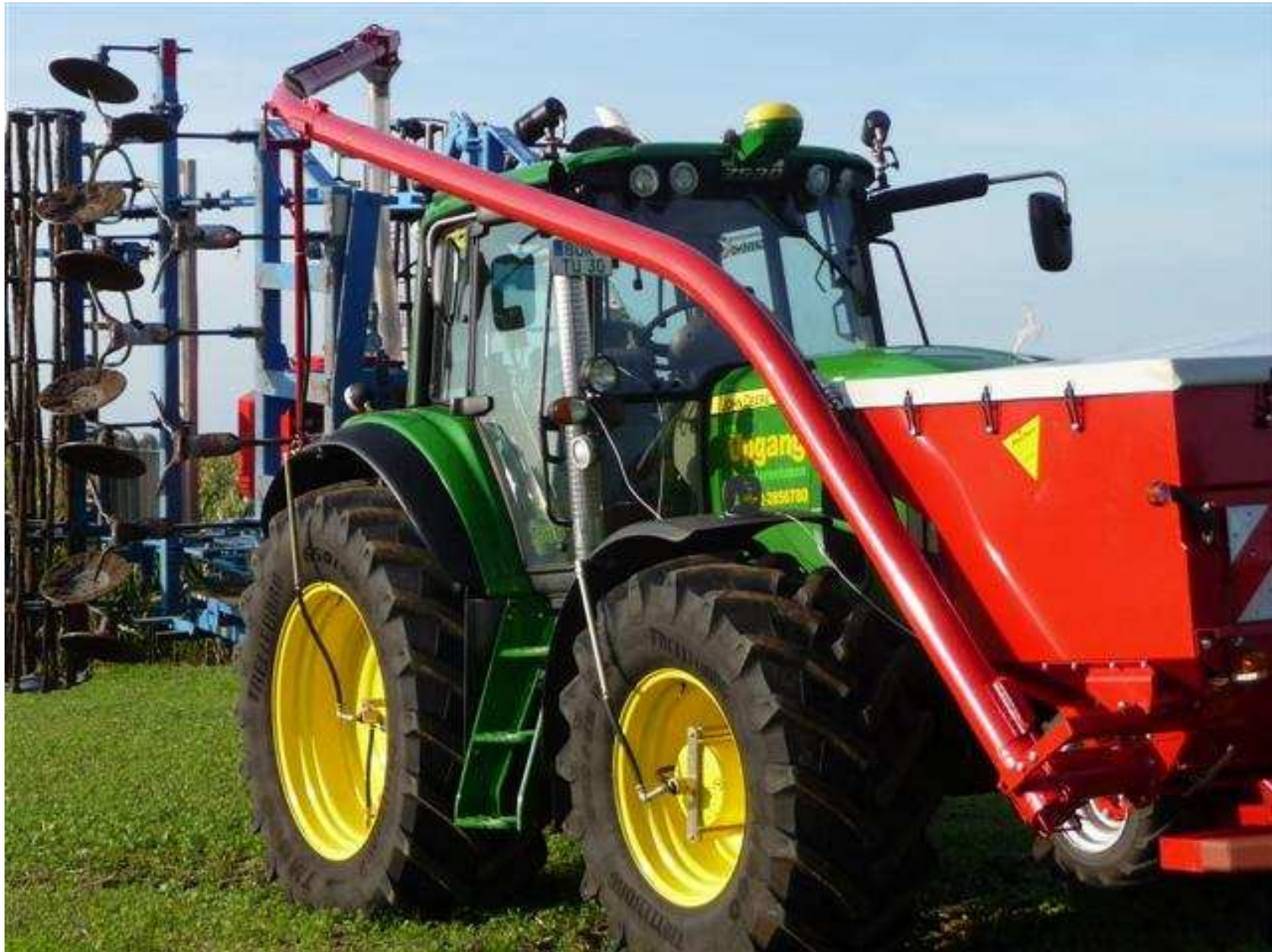
Fronttank FT2527 Inhalt 2700 Liter, Tankbreite 2,5 m Reifenpacker REPA - mit hydraul. Gewichtsausgleich Umladespirale Ø125 mm in Kombination mit Drille
