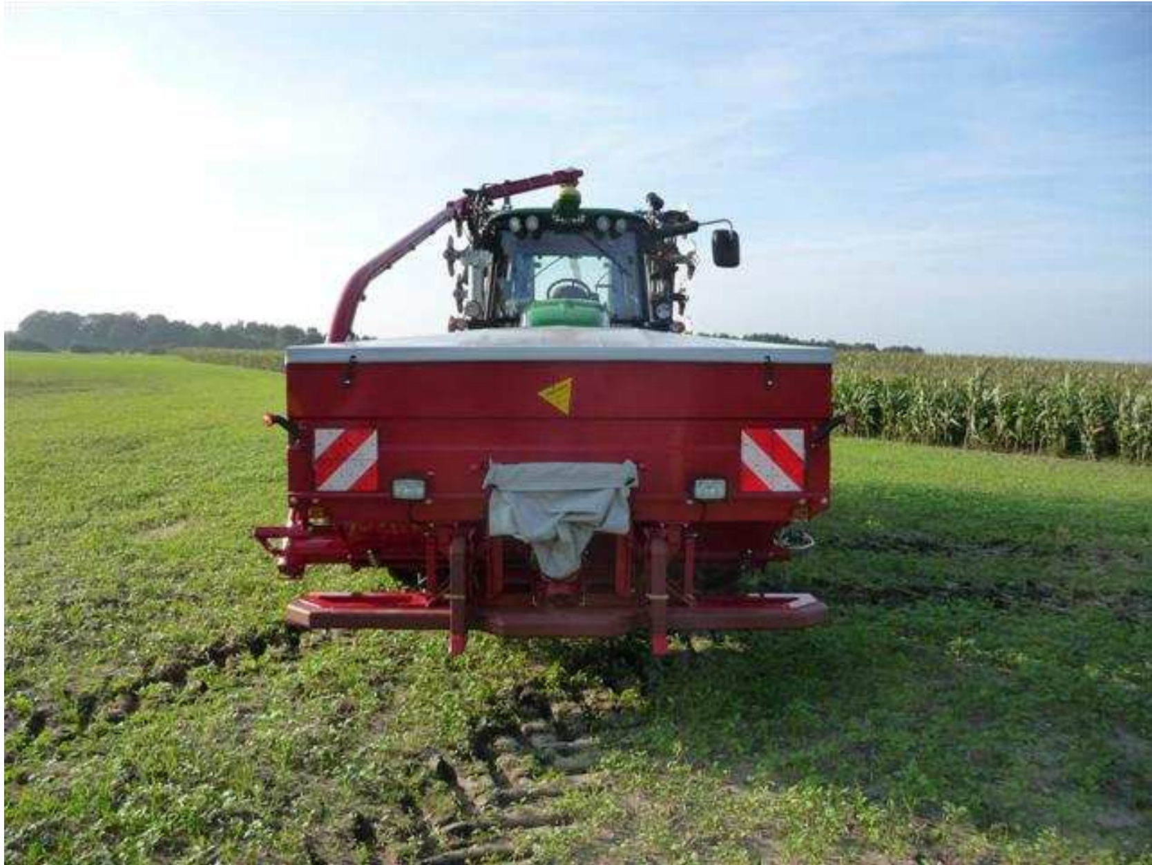
Fronttank FT2527 Inhalt 2700 Liter, Tankbreite 2,5 m Reifenpacker REPA - mit hydraul. Gewichtsausgleich Umladespirale Ø125 mm
