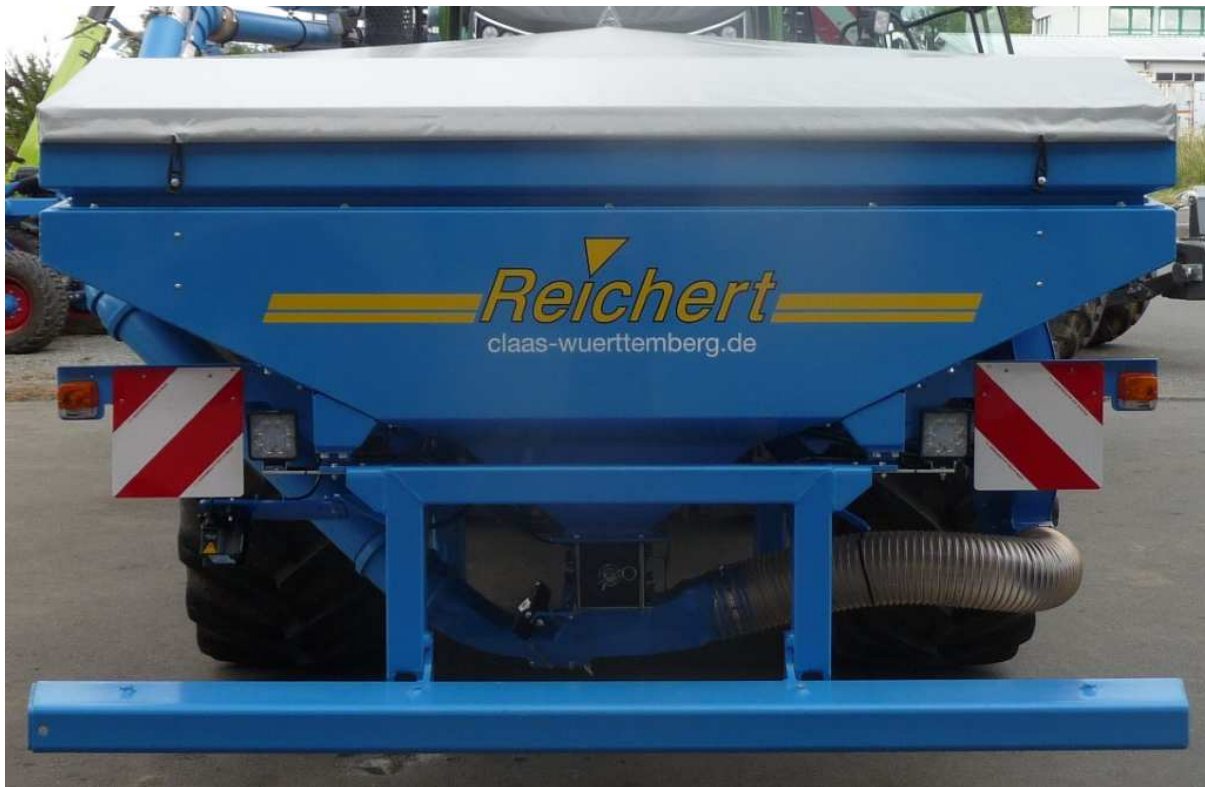
Bild 1 Gewichtsstoßstange - aus Rechteckrohr, befüllbar - auch als Auftrittsfläche > zum Befüllen mit Stahl - Leergewicht ca. 100 kg - Gewicht gefüllt ca. 400 kg > Auflagemöglichkeit für bis zu 2 Gewichtsplatten á 175 kg, max. ca. 750 kg gesamt
