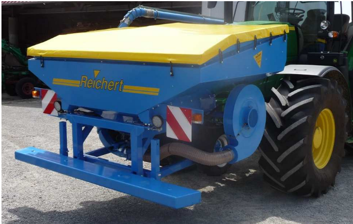
Bild 3 Gewichtsstoßstange - aus Rechteckrohr, befüllbar - auch als Auftrittsfläche > zum Befüllen mit Stahl - Leergewicht ca. 100 kg - Gewicht gefüllt ca. 400 kg > Auflagemöglichkeit für bis zu 2 Gewichtsplatten á 175 kg, max. ca. 750 kg gesamt
