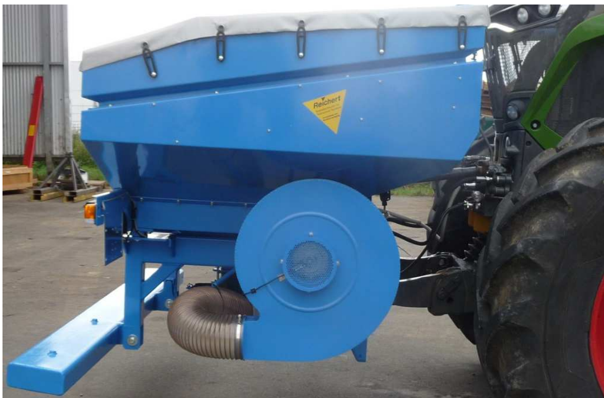
Bild 2 Gewichtsstoßstange - aus Rechteckrohr, befüllbar - auch als Auftrittsfläche
