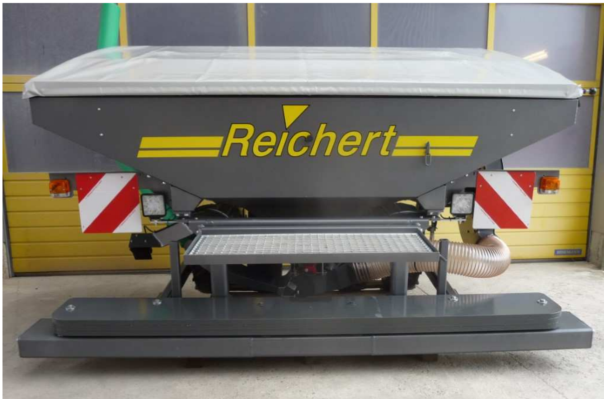
Bild 4 Gewichtsstoßstange - aus Rechteckrohr, befüllbar - auch als Auftrittsfläche > mit bis zu 2 Gewichtsplatten á 175 kg, max. ca. 750 kg Gesamtgewicht
