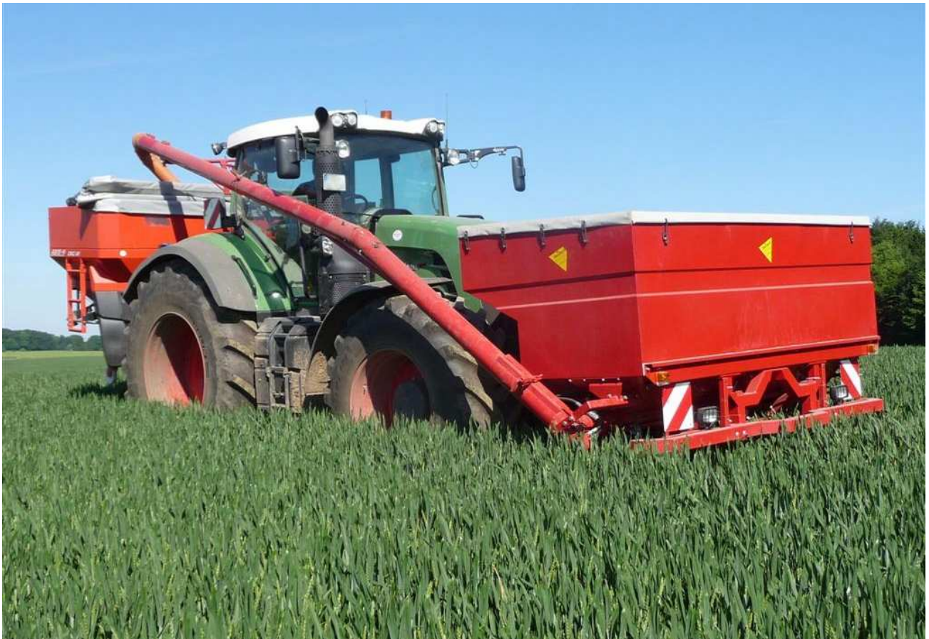
Fronttank FT2840 Inhalt 4000 Liter, Tankbreite 2,80 m Umladeschnecke Ø150 mm in Kombination mit Düngerstreuer - mit langer Stosstange mit Arbeitsscheinwerfern, Warntafeln (Wunschausrüstung)
