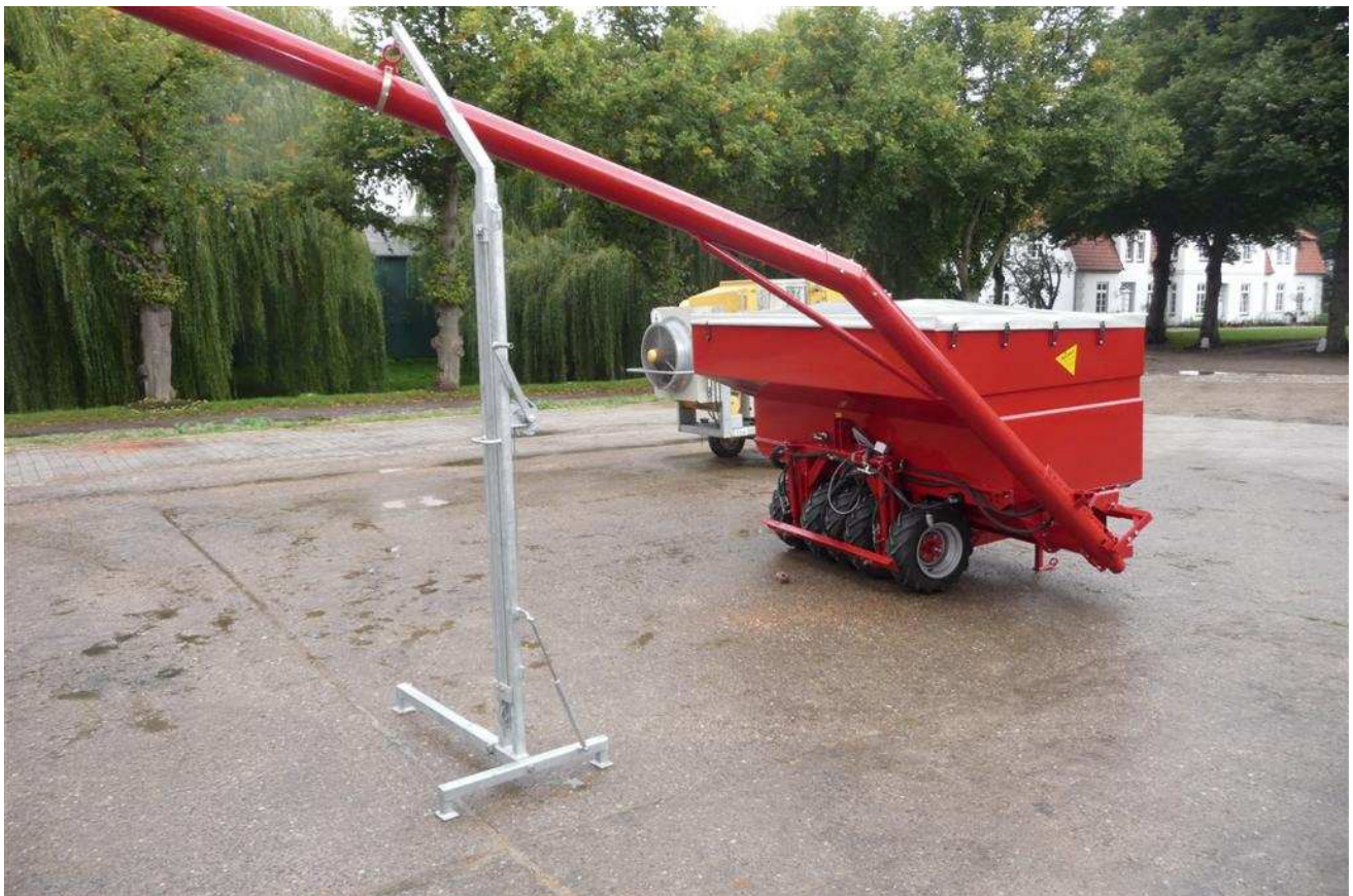
Fronttank FT2840 Inhalt 4000 Liter, Tankbreite 2,80 m Umladeschnecke Ø150 mm, abgebaut - mit Abnahmegestell - mit Reifenpacker REPA mit hydraul. Aushebung und hydraul. Gewichtsausgleich (Wunschausrüstung)
