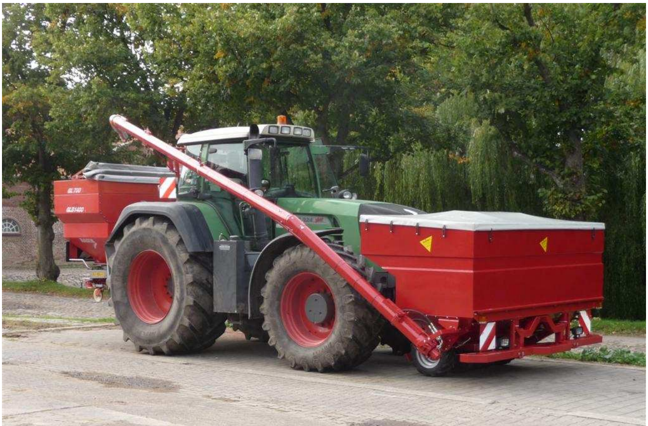
Fronttank FT2840 Inhalt 4000 Liter, Tankbreite 2,80 m Umladeschnecke Ø150 mm in Kombination mit Düngestreuer - mit Reifenpacker REPA mit hydraul. Aushebung und hydraul. Gewichtsausgleich (Wunschausrüstung)
