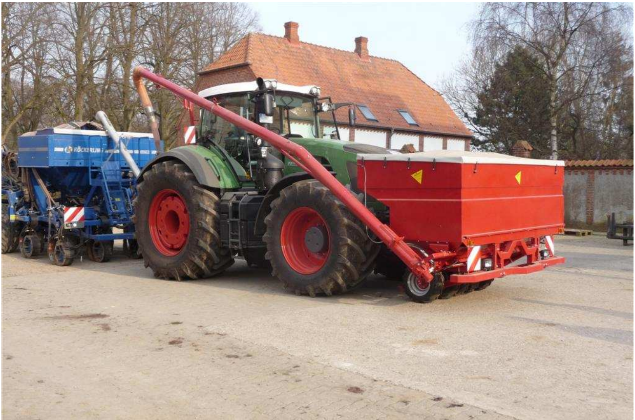
Fronttank FT2840 Inhalt 4000 Liter, Tankbreite 2,80 m Umladeschnecke Ø150 mm in Kombination mit Drille - mit Reifenpacker REPA mit hydraul. Aushebung und hydraul. Gewichtsausgleich (Wunschausrüstung)
