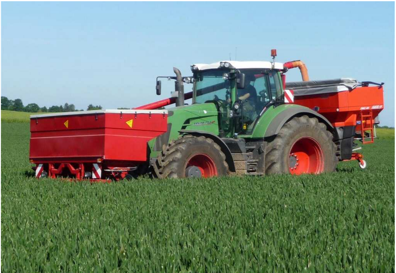
Fronttank FT2840 Inhalt 4000 Liter, Tankbreite 2,80 m Umladeschnecke Ø150 mm in Kombination mit Düngerstreuer - mit langer Stossstange mit Arbeitsscheinwerfern, Warntafeln (Wunschausrüstung)
