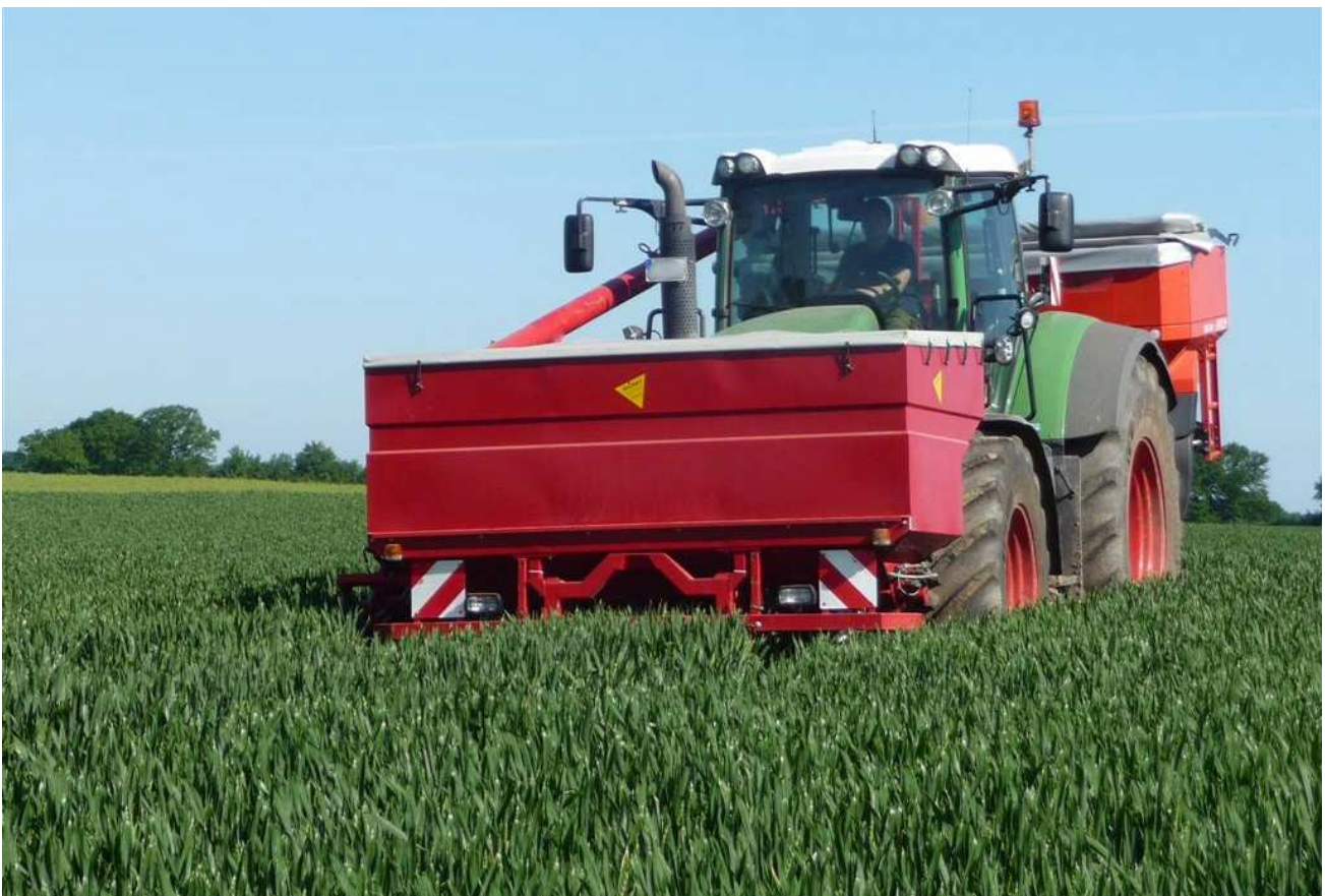
Fronttank FT2840 Inhalt 4000 Liter, Tankbreite 2,80 m Umladeschnecke Ø150 mm in Kombination mit Düngerstreuer - mit langer Stosstange mit Arbeitsscheinwerfern, Warntafeln (Wunschausrüstung)
