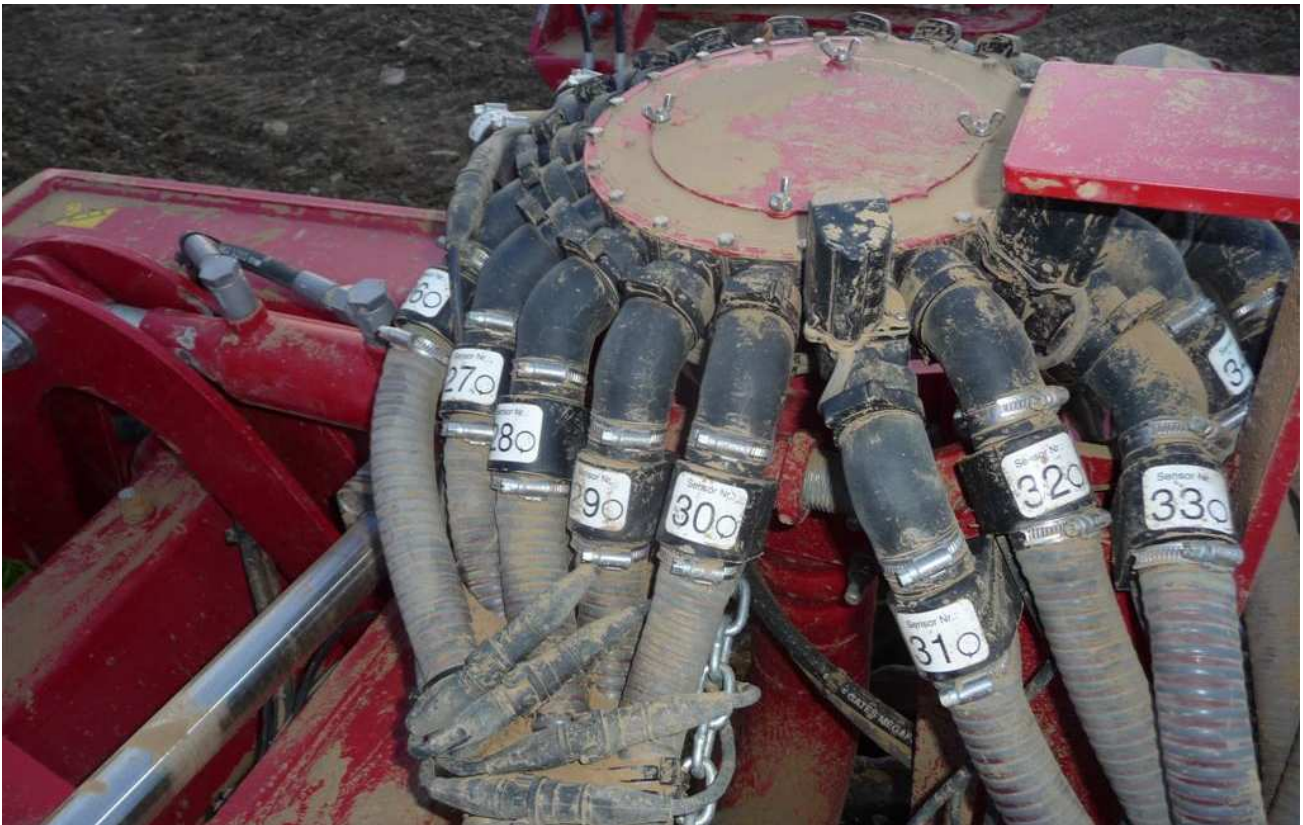
Saatflussüberwachung - Montage am Verteiler, für Säs Schlauch Ø30 mm - Horsch-Säverteiler
