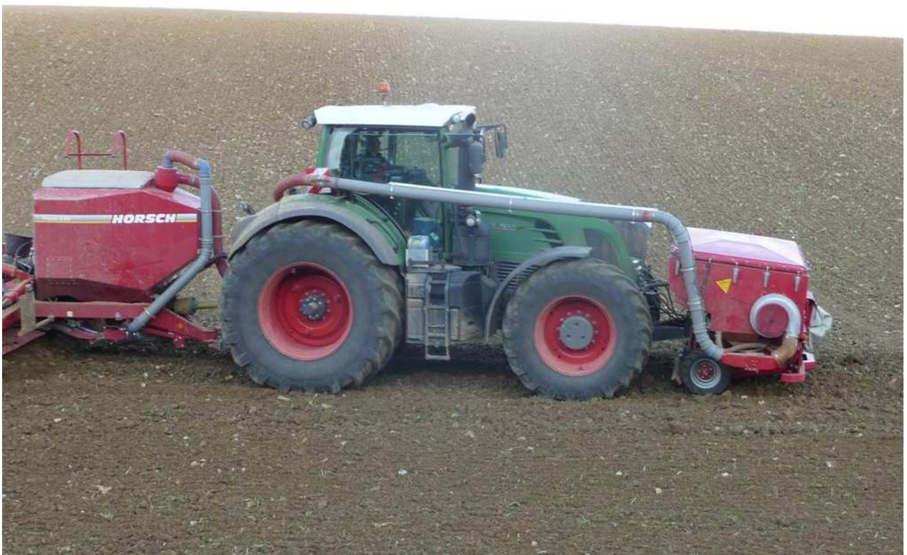
Front-Drucktank FDT 2527 Inhalt 2700 Liter, Tankbreite 2,50 m - mit Dosierschnecke - mit Förderleitung Ø125 mm - mit Reifenpacker mit hydraulischem Gewichtsausgleich, hydraulisch aushebbar (Wunschausrüstung) pneumatische Umladung in Sätank von Horsch KR, Arbeitsbreite 6 m - mit Zyklon
