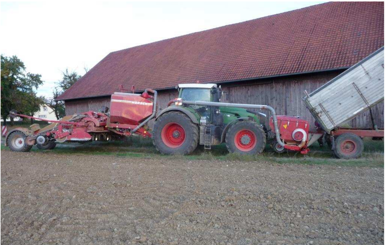
Beladung direkt aus Kipper in Klapptrichter der Befüllschnecke - Befüllschnecke Ø200 mm - Leistung ca. 50 t/h - mit Planetrichter, klappbar Front-Drucktank FDT 2527 Inhalt 2700 Liter, Tankbreite 2,50 m Pneumatische Umladung in Sätank der Horsch KR, Arbeitsbreite 6 m
