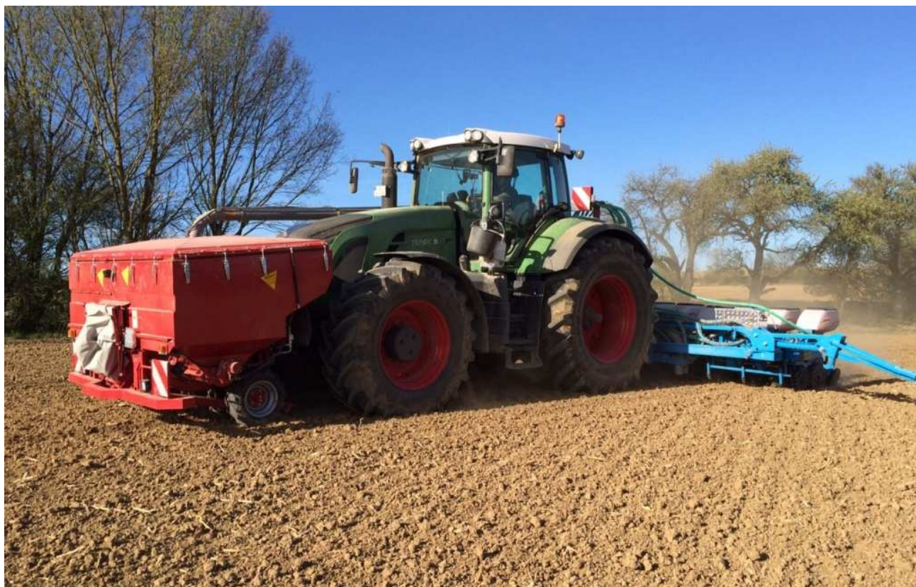
Front-Drucktank FDT 2527 Inhalt 2700 Liter, Tankbreite 2,50 m - mit Reifenpacker mit hydraulischem Gewichtsausgleich, hydraulisch aushebbar (Wunschausrüstung) - mit Stoßstange lang, Arbeitsscheinwerfern, Warntafeln (Wunschausrüstung) - mit Klapptritt (Wunschausrüstung) in Kombination mit Maissägerät, Arbeitsbreite 6 m, Unterfußdüngung
