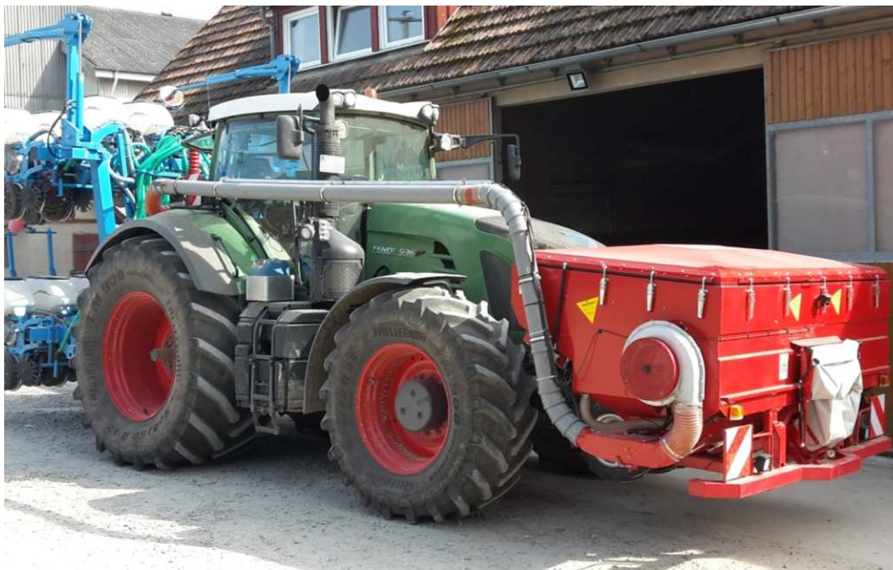
Front-Drucktank FDT 2527 Inhalt 2700 Liter, Tankbreite 2,50 m - mit Dosierschnecke - mit Förderleitung Ø125 mm - mit Befüllschnecke Ø200 mm mit Planettrichter, zugeklappt (Wunschausrüstung) - mit Reifenpacker mit hydraulischem Gewichtsausgleich, hydraulisch aushebbar (Wunschausrüstung) in Kombination mit Maissägerät, Arbeitsbreite 6 m, Unterfußdüngung
