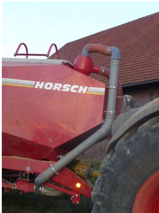
pneumatische Umladung in Sätank von Horsch KR, Arbeitsbreite 6 m - mit Zyklon in Kombination mit Front-Drucktank FDT 2527 - mit Dosierschnecke - mit Förderleitung Ø125 mm
