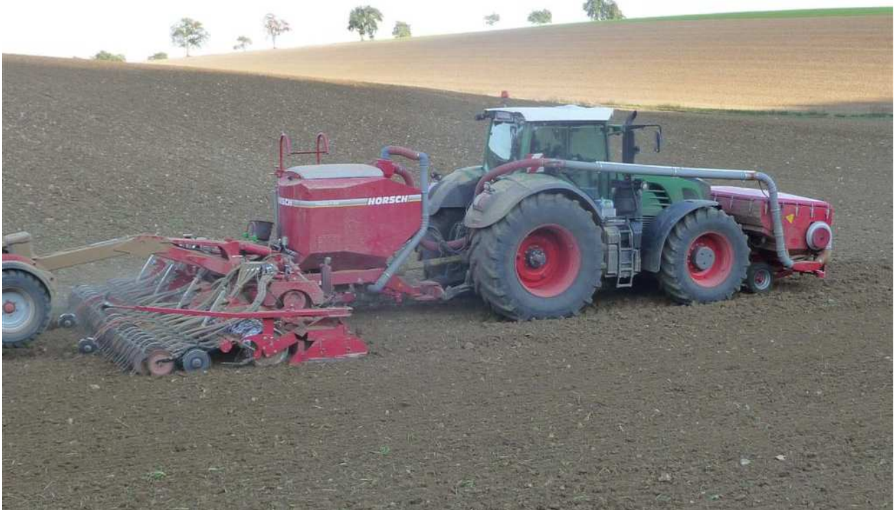
Front-Drucktank FDT 2527 Inhalt 2700 Liter, Tankbreite 2,50 m - mit Dosierschnecke - mit Förderleitung Ø125 mm - mit Reifenpacker mit hydraulischem Gewichtsausgleich, hydraulisch aushebbar (Wunschausrüstung) pneumatische Umladung in Sätank von Horsch KR, Arbeitsbreite 6 m - mit Zyklon
