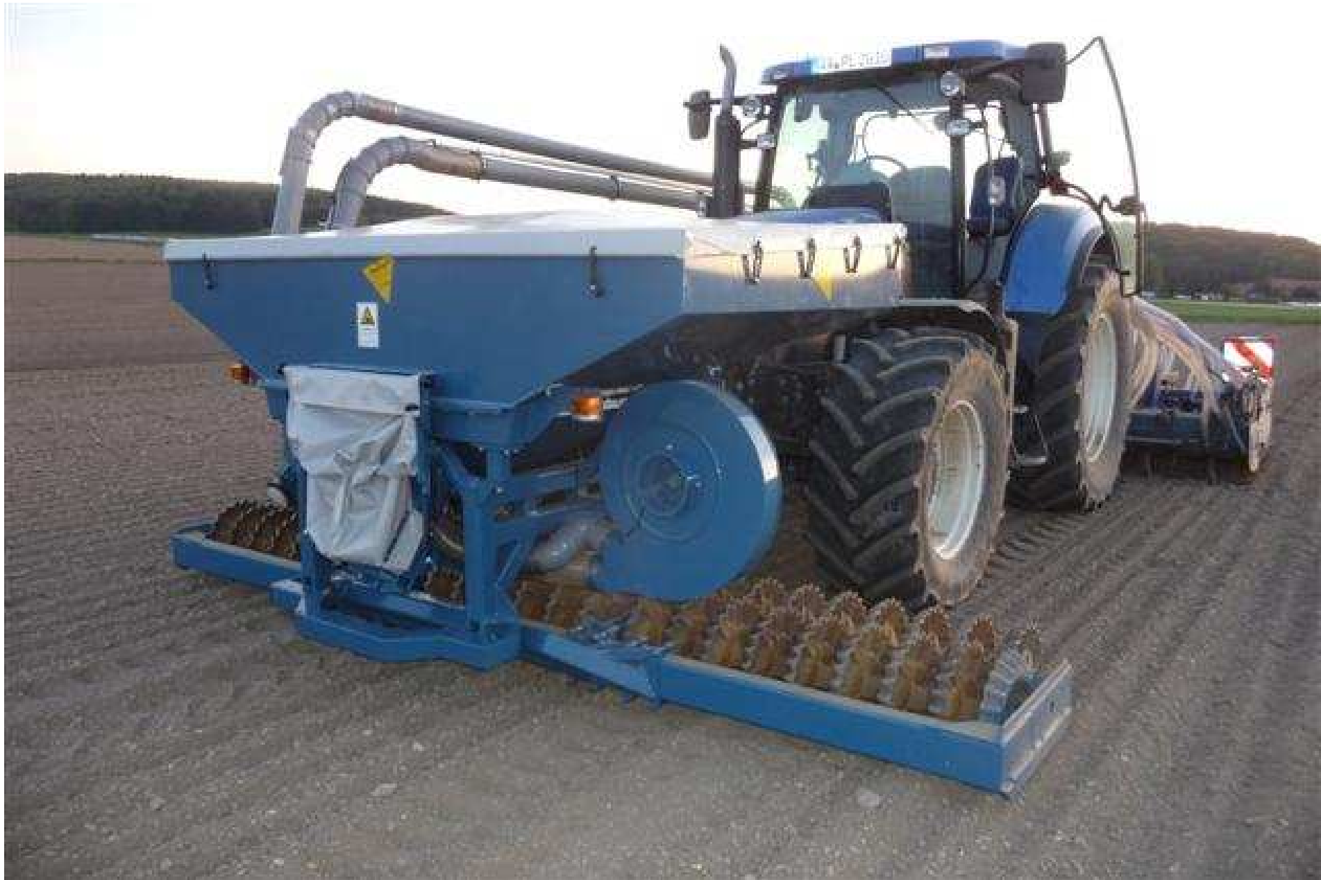
Fronttank FTK 2518 - mit 2 Horsch-Dosiergeräten - mit Güttlerwalze - mit Befüllschnecke
