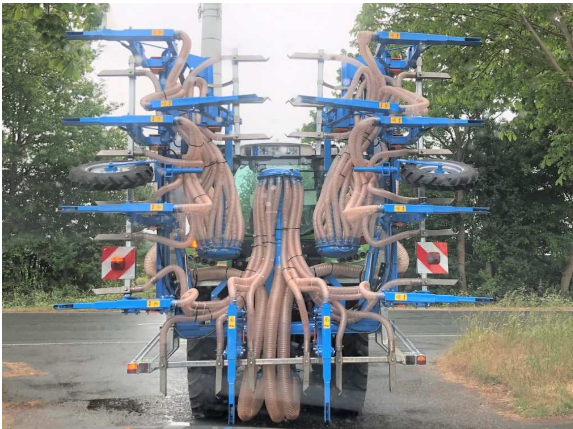
Heckdüngerahmen HDR 9/12, hydraulisch 4-fach klappbar 9 m Arbeitsbreite, 12 Reihen mit Umschaltung: Unterfußdüngung in der Reihe oder seitliche Reihendüngung
