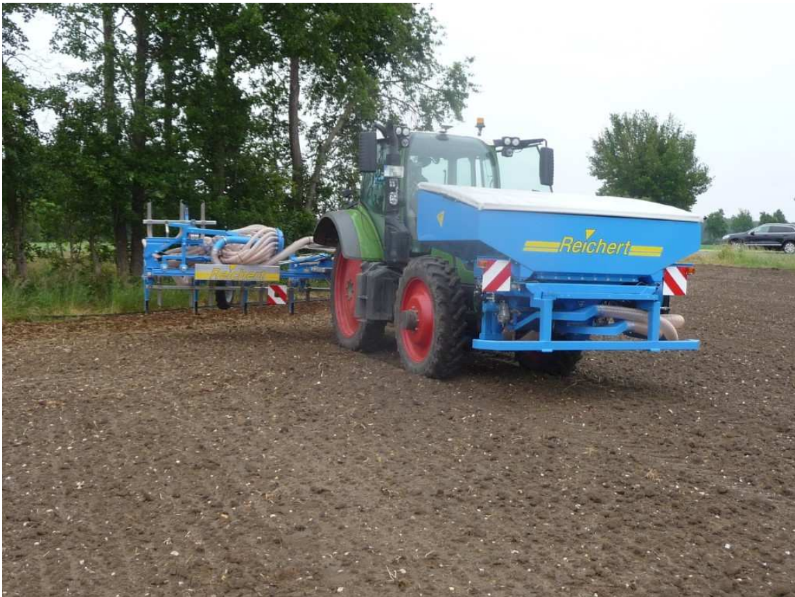
Fronttank FTKVL 2526WT mit 3x Reichert-Druckdosierung Inhalt 2600 Liter, Tankbreite 2,5 m Heckdüngerahmen HDR 9/12: - hydraulisch 4-fach klappbar - halb auseinandergeklappt
