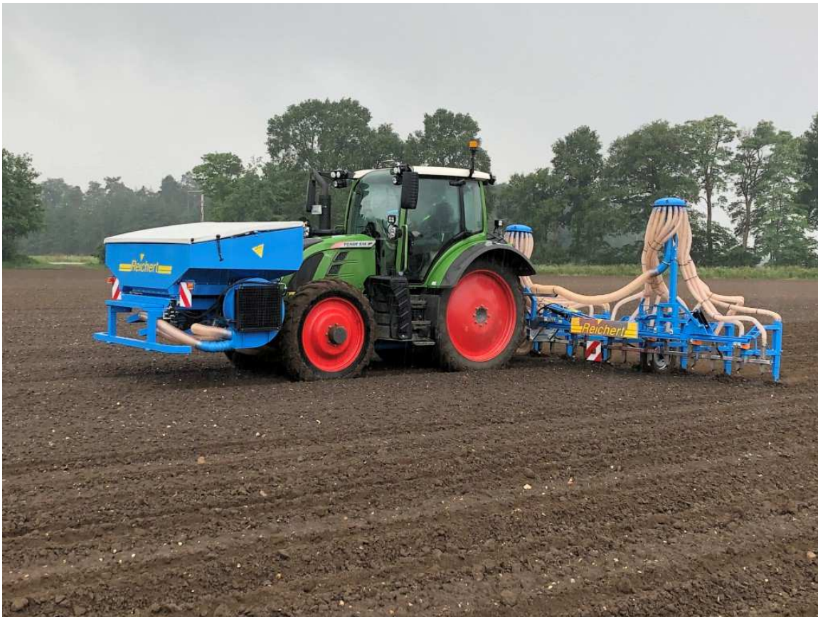
Fronttank FTKVL 2526WT mit 3x Reichert-Druckdosierung in Kombination mit Heckdüngerahmen HDR 9/12
