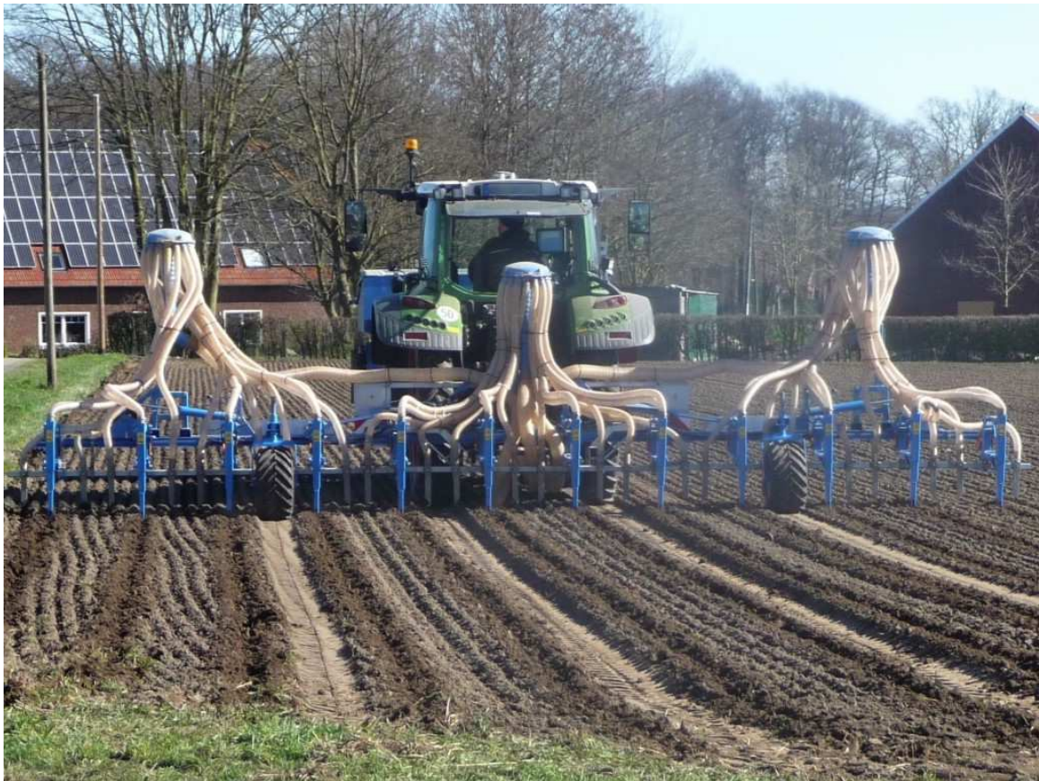
Heckdüngerahmen HDR 9/12 9 m Arbeitsbreite, 12 Reihen - 3 Teilbreiten á 3 m: unterschiedliche Ausbringmenge für jede 3-Meter-Teilbreite möglich - mit Umschaltung: Unterfußdüngung in der Reihe oder seitliche Reihendüngung
