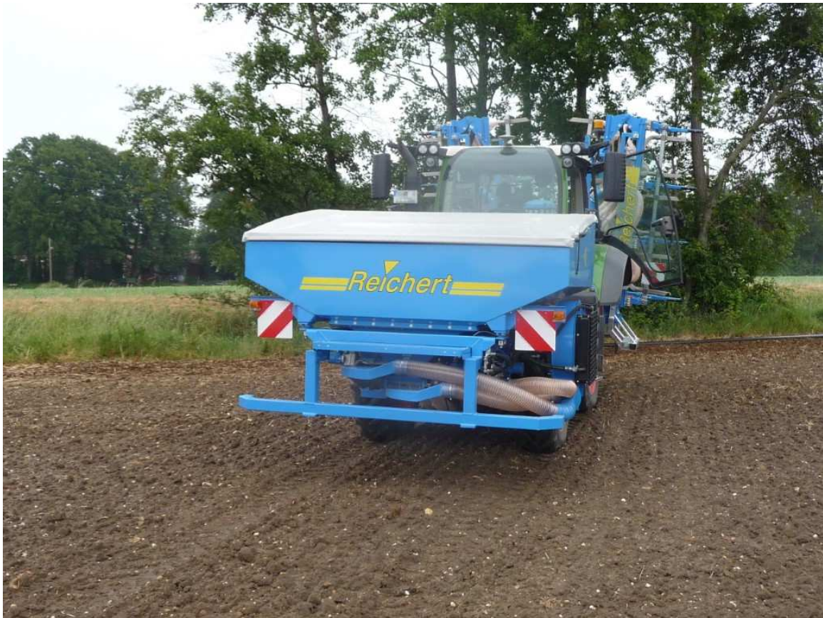
Fronttank FTKVL 2526WT mit 3x Reichert-Druckdosierung Inhalt 2600 Liter, Tankbreite 2,5 m Heckdüngerahmen HDR 9/12: - hydraulisch 4-fach klappbar - zusammengeklappt
