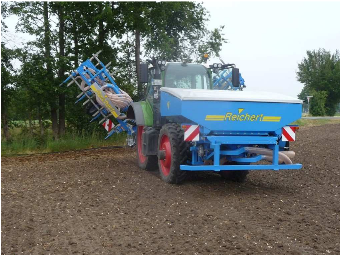
Fronttank FTKVL 2526WT mit 3x Reichert-Druckdosierung Inhalt 2600 Liter, Tankbreite 2,5 m Heckdüngerahmen HDR 9/12: - hydraulisch 4-fach klappbar - beim Auseinanderklappen
