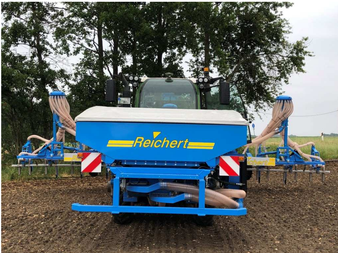
Fronttank FTKVL 2526WT mit 3x Reichert-Druckdosierung Inhalt 2600 Liter, Tankbreite 2,5 m Heckdüngerahmen HDR 9/12: - hydraulisch 4-fach klappbar - auseinandergeklappt
