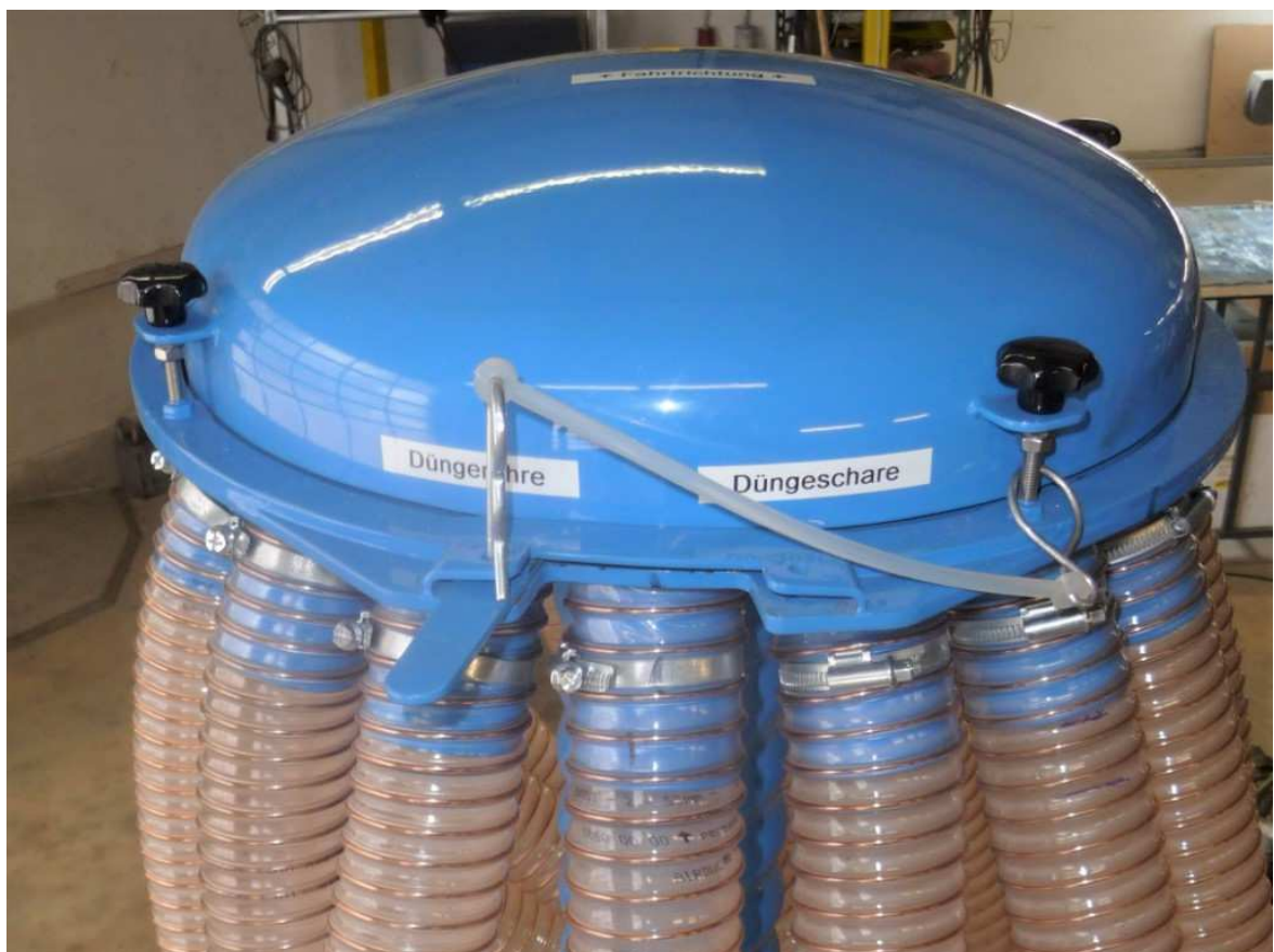
HDR 9/12 mit 3 Stück Verteilerköpfe, Sonderausführung Umschaltung: Umschaltung: Unterfußdüngung in der Reihe oder seitliche Reihendüngung
