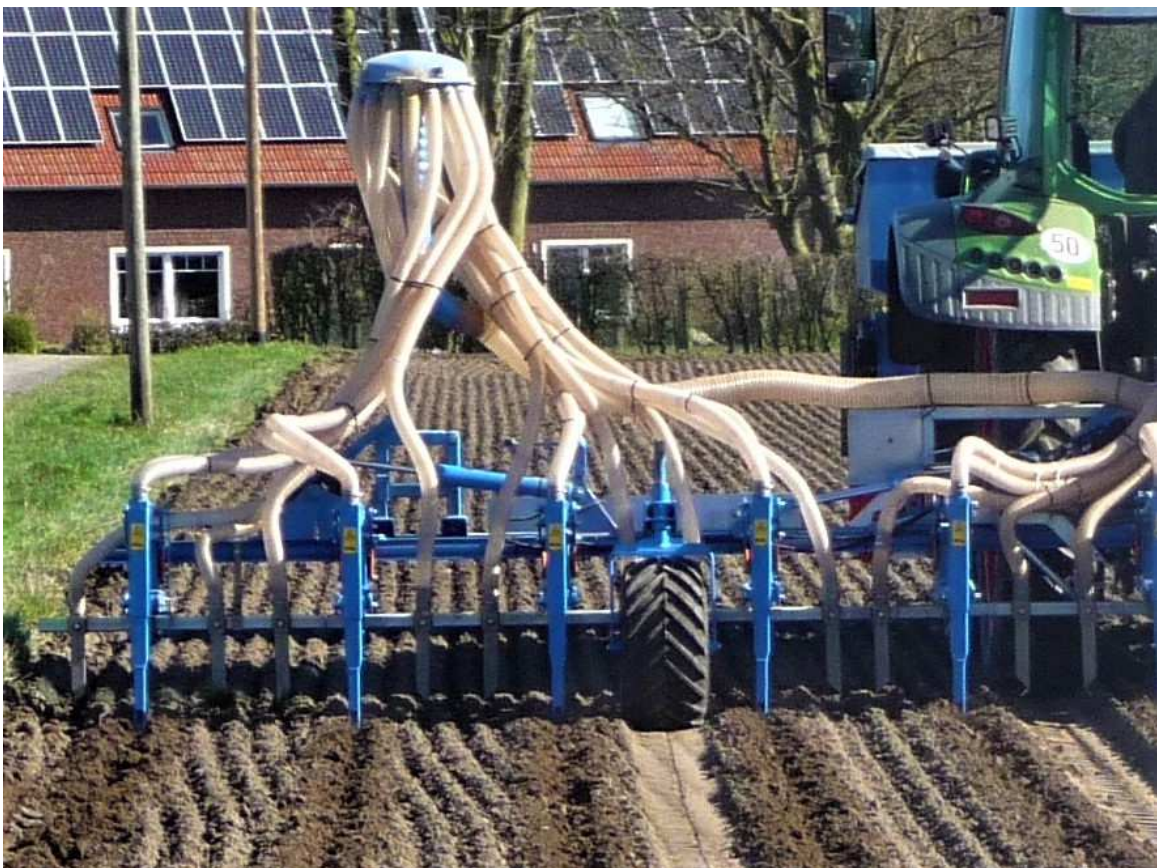
Heckdüngerahmen HDR 9/12 9 m Arbeitsbreite, 12 Reihen bei abgeklappten Düngescharen: Unterfußdüngung in der Reihe
