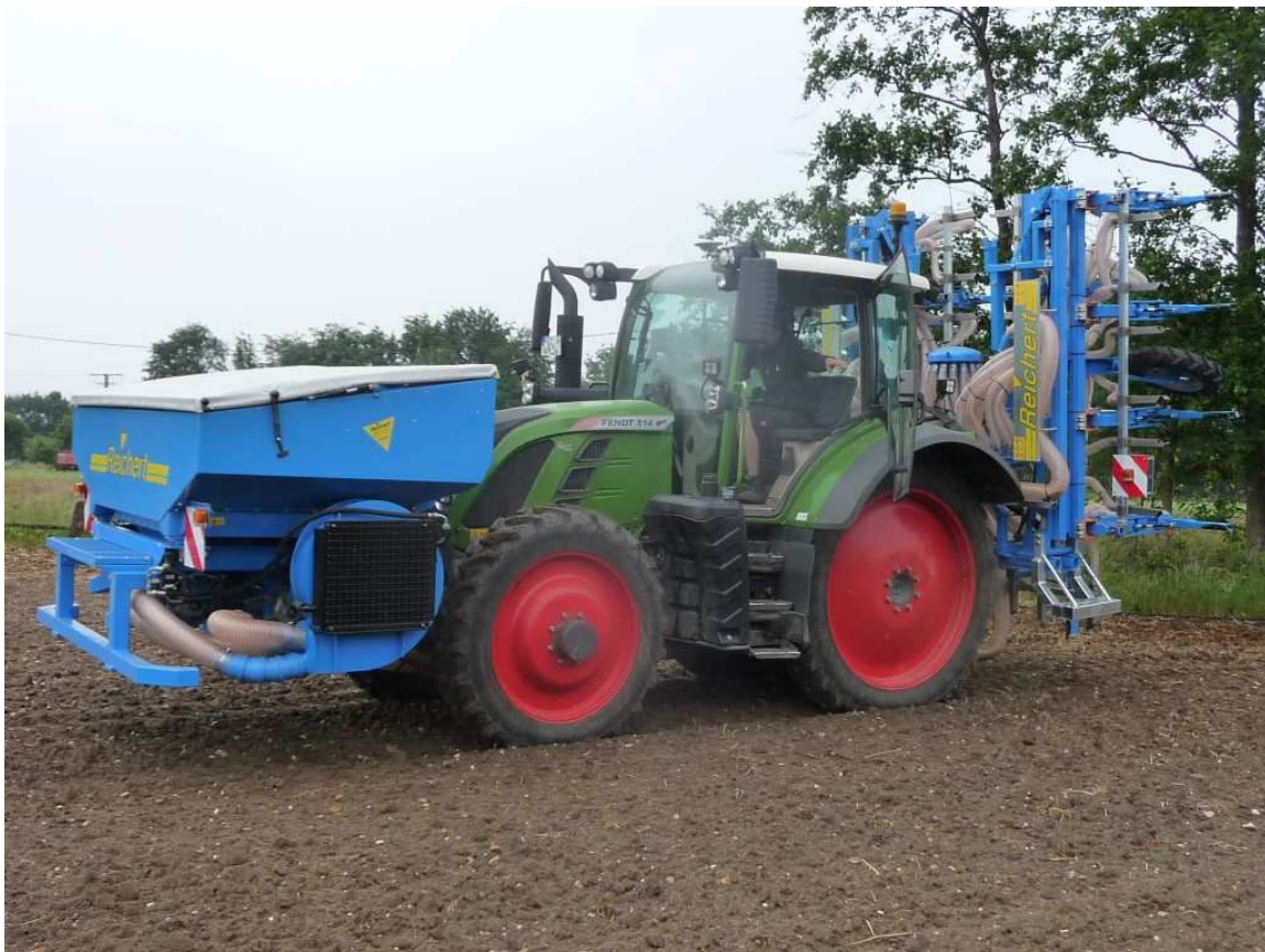
Fronttank FTKVL 2526WT mit 3x Reichert-Druckdosierung mit Wunschausrüstung: - Klappdach - Auftritt - Stoßstange - Wiegeeinrichtung - Warntafeln
