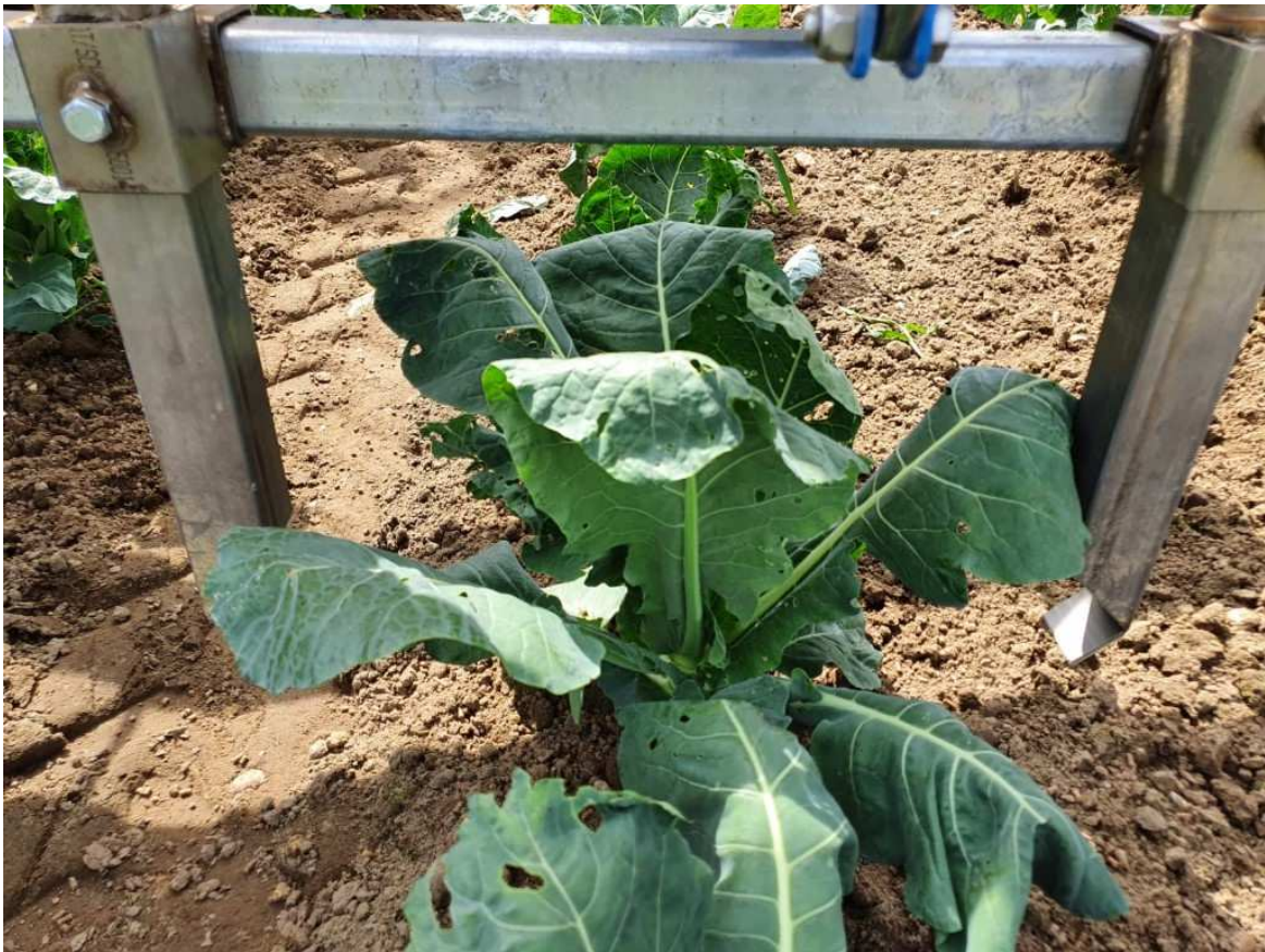
Heckdüngerahmen HDR 9/12 9 m Arbeitsbreite, 12 Reihen bei hochgeklappten Düngescharen (mit Gasfeder-Unterstützung): seitliche Reihendüngung
